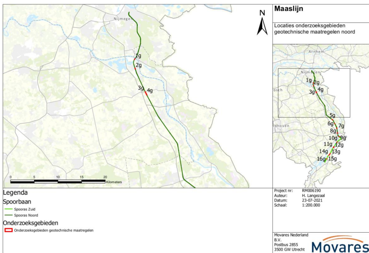
Figuur 3.3: Onderzoeklocaties waar aanvullende geotechnische maatregelen benodigd zijn in het noordelijk deel van de Maaslijn. Nummering komt overeen met de nummering in Tabel 3-3.
