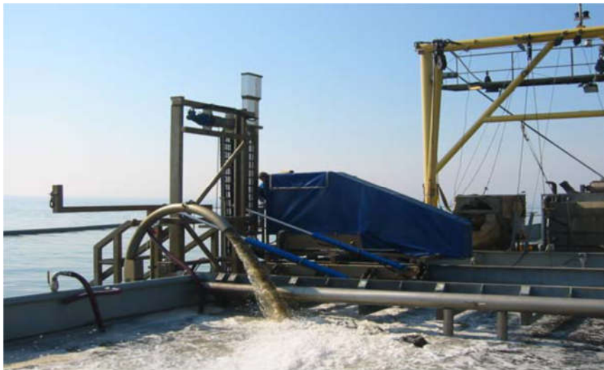
Figuur 4: mosselzaad wordt met een waterstroom aan boord gebracht
