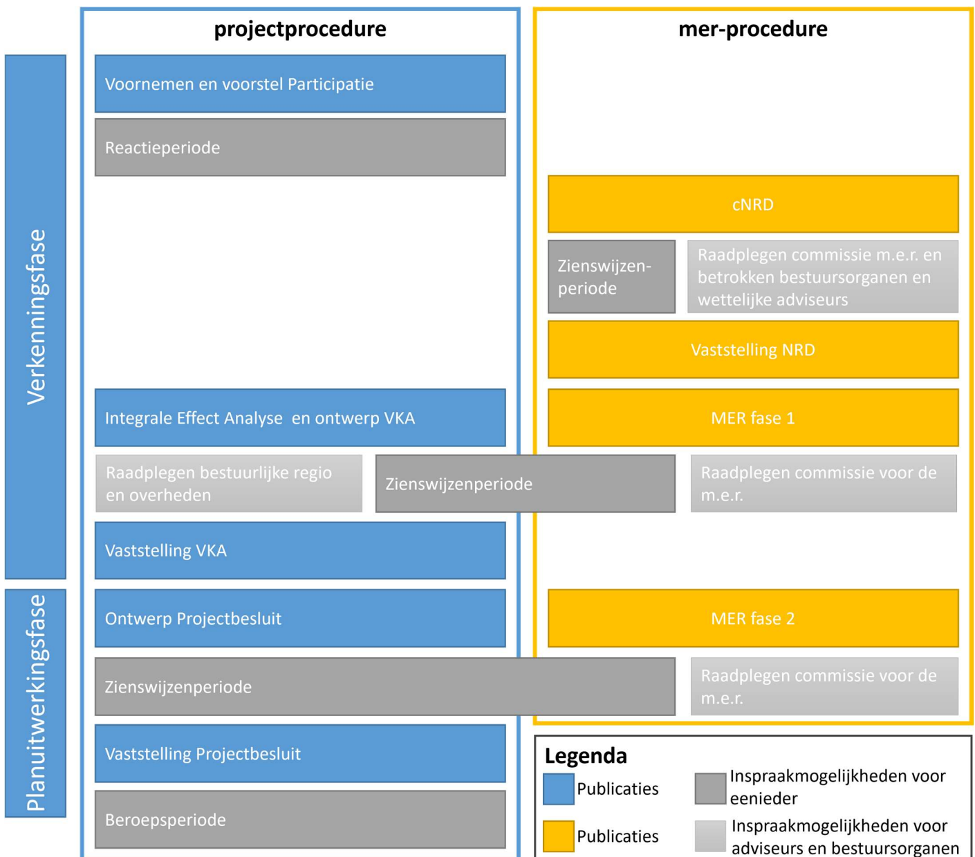
Figuur 2-1 Projectprocedure met de hieraan gekoppelde m.e.r.-procedure (de gekoppelde vergunningprocedures zijn niet opgenomen)
