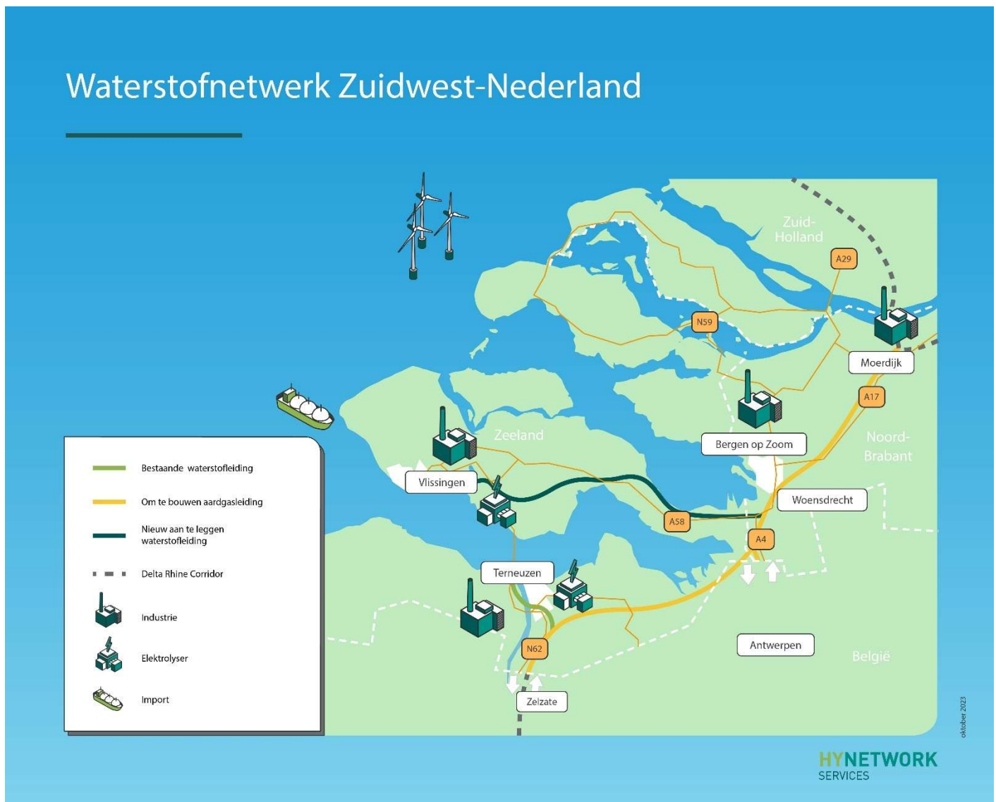
Figuur 3-4. Waterstofnetwerk Zuidwest-Nederland met bestaande en nieuwe leidingen
