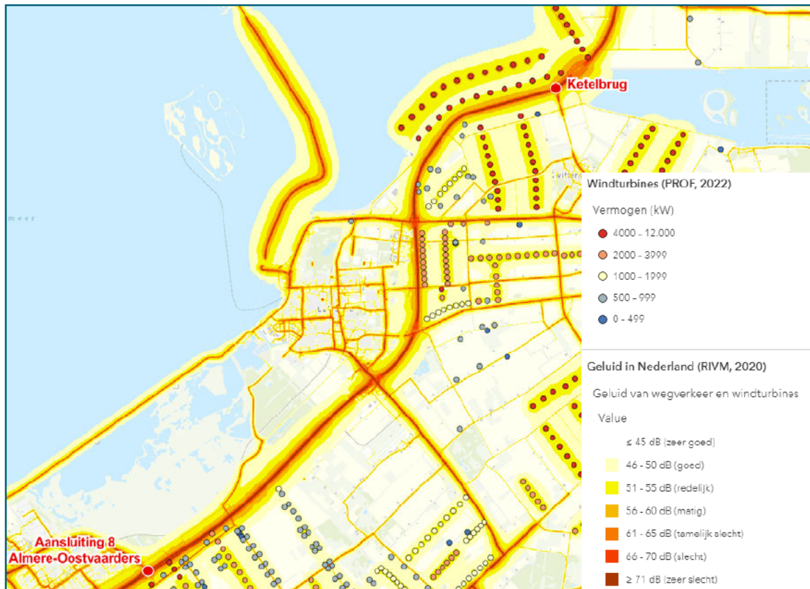
Afbeelding 3.6 Geluid van wegverkeer en windturbines [ref. 3]
