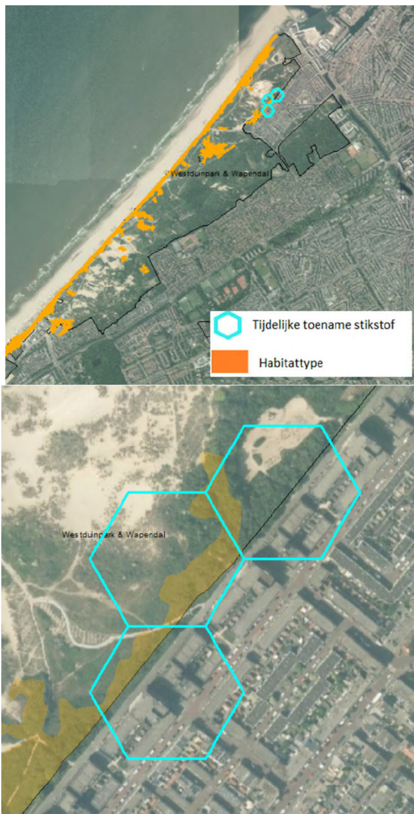
Figuur 5.1 Hexagonen volgens AERIUS Calculator (versie 2023) met een toename in H2120 en overschrijding van de KDW. Uit de luchtfoto blijkt dat het habitatype ontbreekt, ter plaatse is alleen bos aanwezig.
