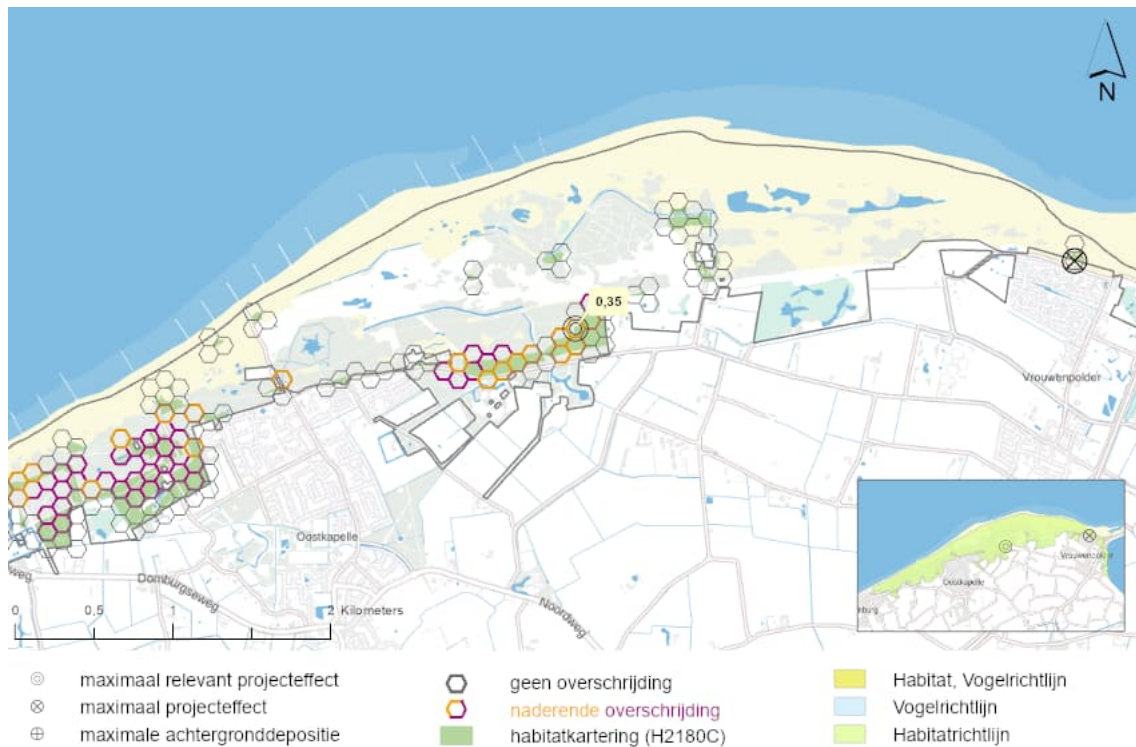
Figuur 6.7: De locatie in het Natura 2000-gebied Manteling van Walcheren met de maximale relevante toename aan stikstofdepositie op Duinbossen (binnenduinrand) (H2180C).
