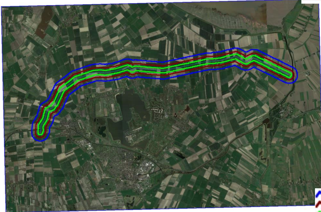
Figuur 5: De warmtestralingscontouren van leiding A-821 met een diepteligging van 1,50 m.
