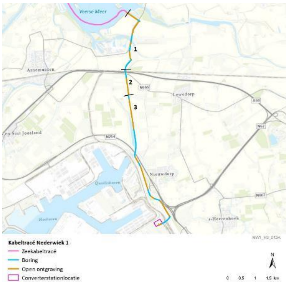
Figuur 5.6 Deeltrajecten vanaf aanlanding tot converterstationlocatie
