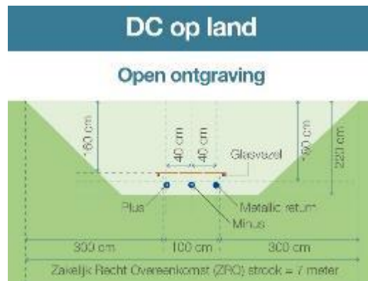
Figuur 2.8. Sleuf bij open ontgraving
