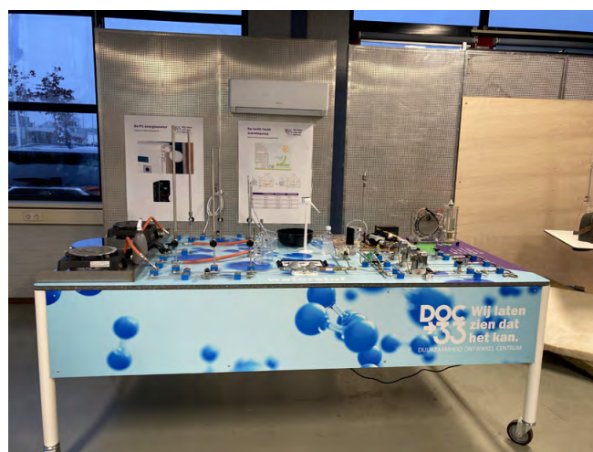
DOC33 heeft een educatieve waterstofafel en waterstofwand ontwikkeld waar een binnenhuisinstallatie wordt gesimuleerd. Monteurs kunnen hiermee oefenen.
