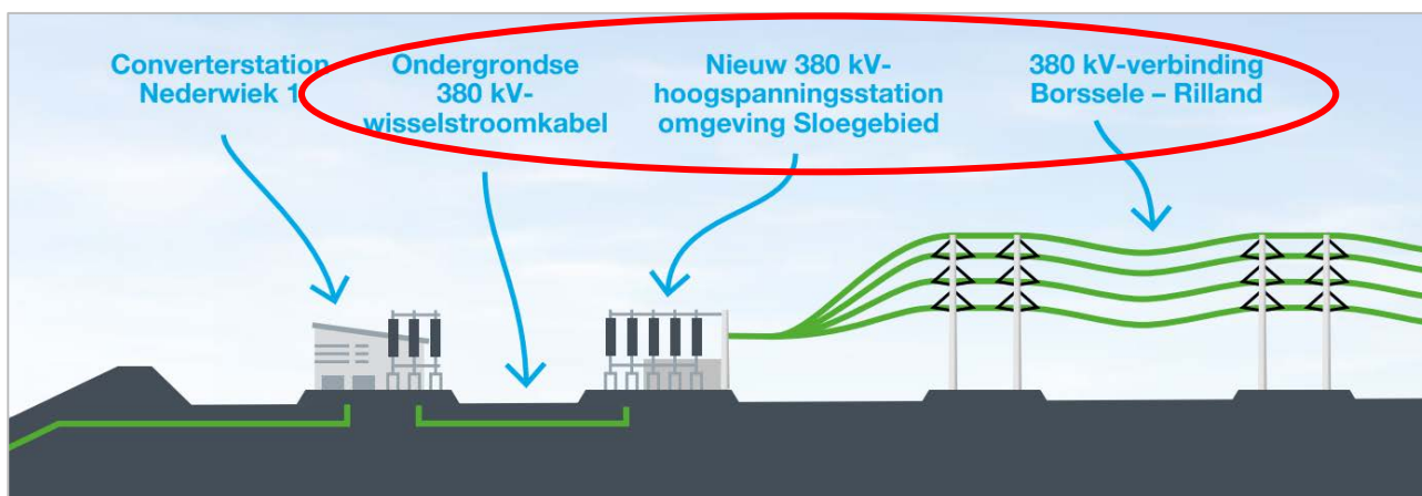
Figuur 2-1 Hoofdonderdelen van het voorgenomen project
