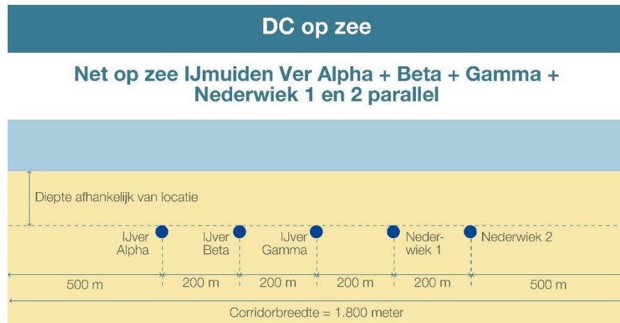
Figuur 2.3: Kabelconfiguratie Netten op zee Nederwiek 1 en 2 en Netten op zee IJmuiden Ver Alpha, Beta en Gamma.
