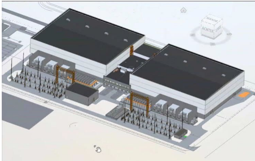
Figuur 2.9: Impressie van het converterstation
