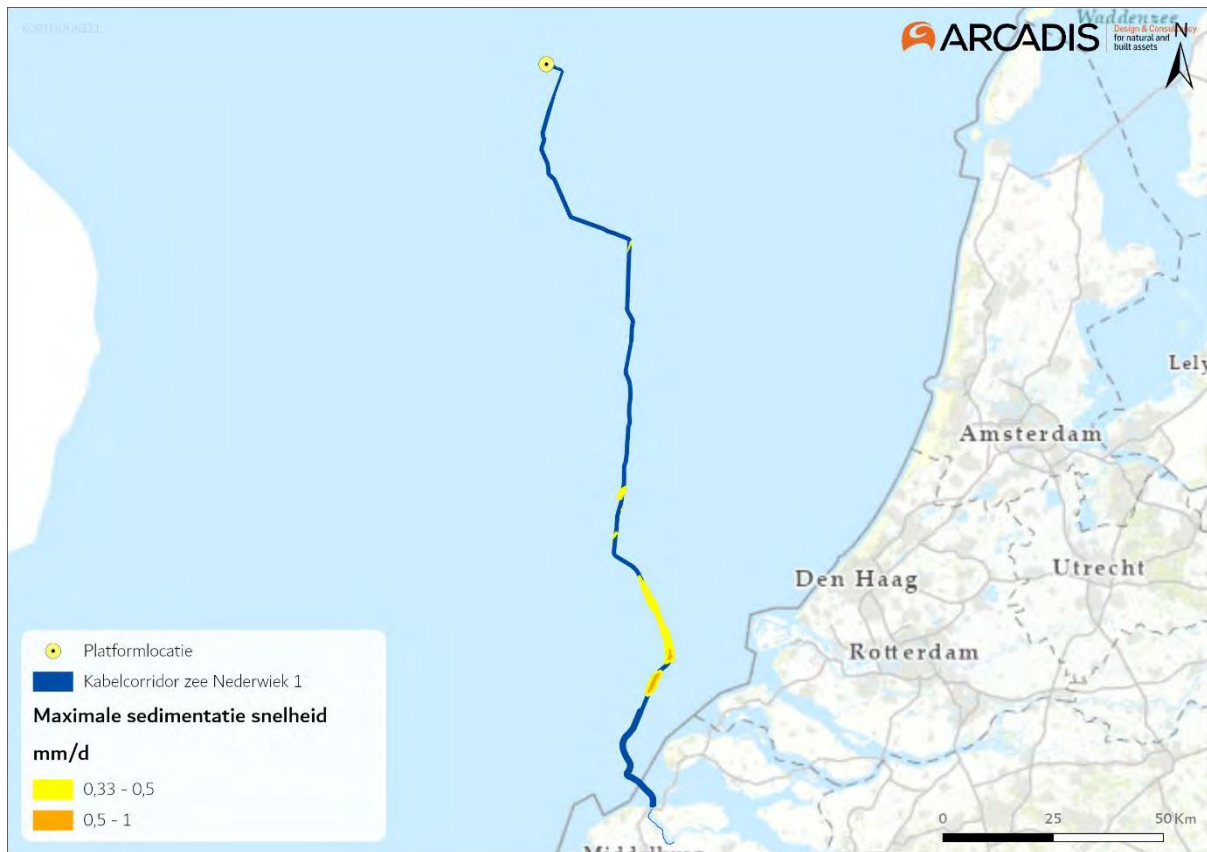
Figuur 3-3 Het areaal waar sedimentatie van boven de 0,33 mg/dag optreedt door de voorgenoemde werkzaamheden van de aanleg van een (2x2)-kabelconfiguratie.
