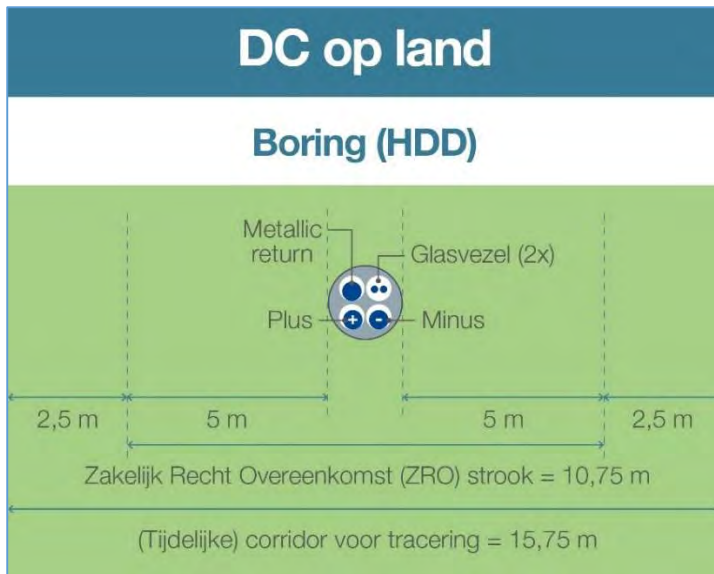
Figuur 2-27 Kabelconfiguratie boring op land Nederwiek 1.
