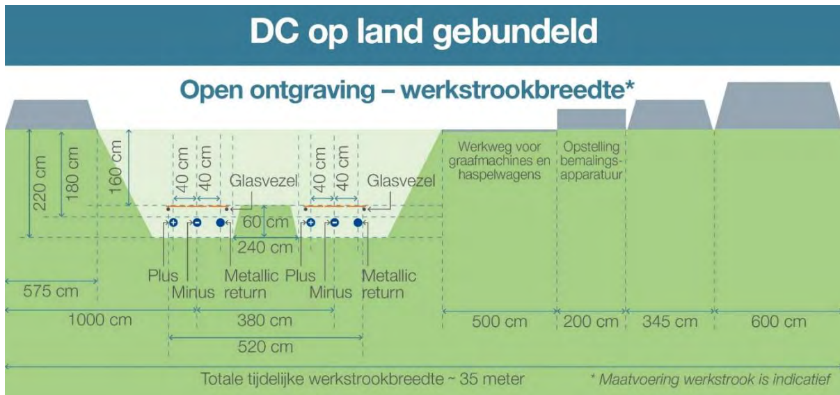
Figuur 2-25: Kabelconfiguratie open ontgraving op land Nederwiek 1 en IJmuiden Ver Alpha.
