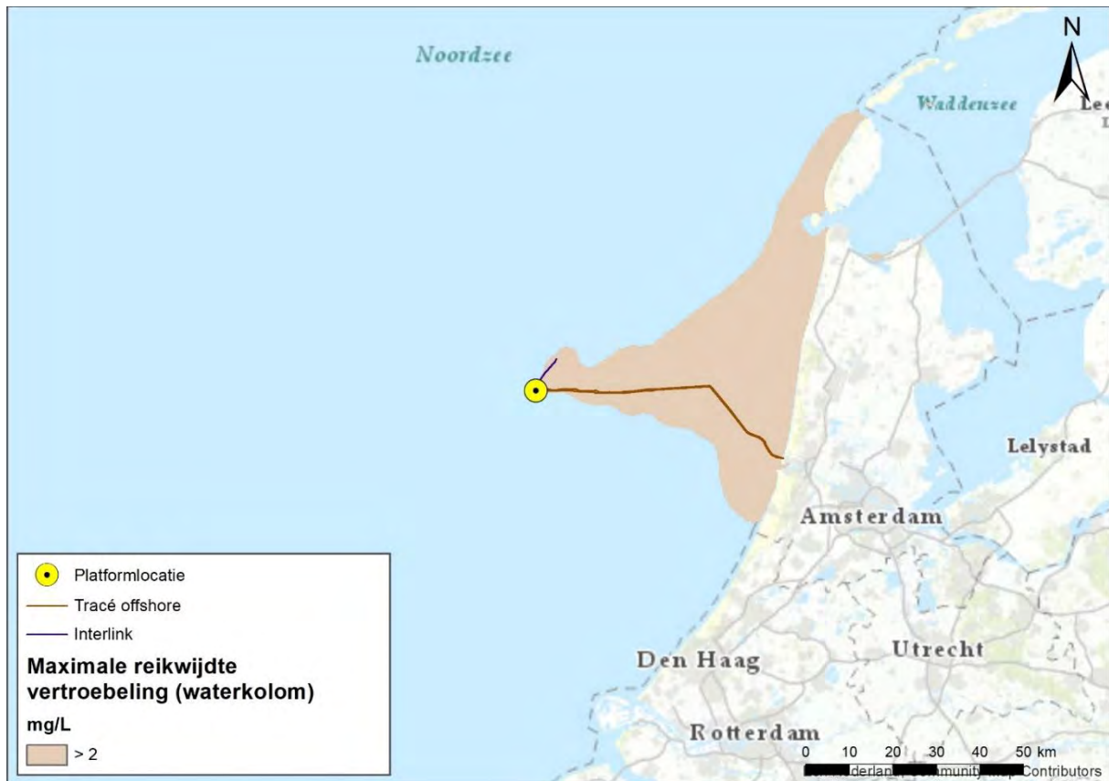
Figuur 6-3 Gebied tot waar de dieptegemiddelde slibwolk (> 2 mg/l) ten gevolge van de werkzaamheden van Hollandse Kust (west Beta) reikt (Arcadis, 2018). N.B. dit is een ouder figuur gebaseerd op oudere data vanuit Hollandse Kust (west Beta).
