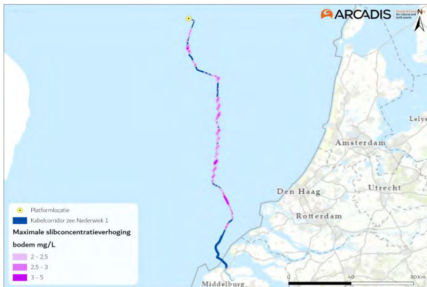
Figuur 3-1 Gebied tot waar de slibwolk ( > 2 \text{ mg/L} ) aan het wateroppervlak (figuur boven), dieptegemiddeld (figuur midden) en op de bodem (figuur onder) maximaal reikt ten gevolge van de werkzaamheden van de aanleg van een (2x2)-kabelconfiguratie.
