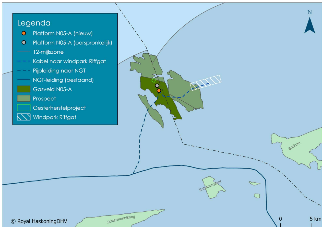
Figuur 3-1: Oorspronkelijke en nieuwe locatie van het productieplatform, inclusief de ligging van de gasvelden en de nieuwe tracés van de gasleiding en de kabel naar windpark Riffgat.
