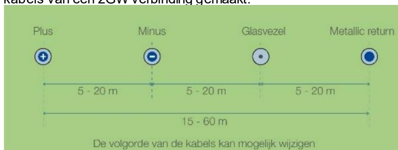
Afbeelding 31b. Een 2 GW-kabelsysteem HDD-kruising primaire waterkering
