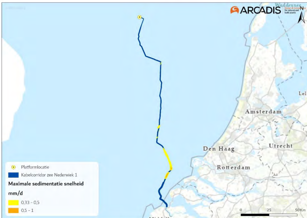
Figuur 2-3 Het areaal waar sedimentatie van boven de 0,33 mg/dag optreedt door de voorgenoemde werkzaamheden van de aanleg van een (2x2)-kabelconfiguratie.
