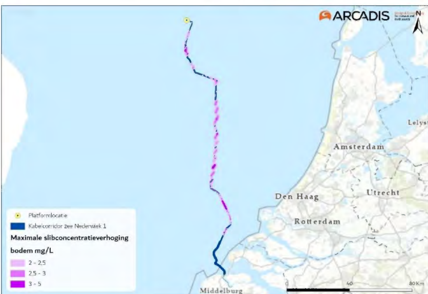
Figuur 2-1 Gebied tot waar de slibwolk (> 2 mg/L) aan het wateroppervlak (figuur boven), dieptegemiddelde (figuur midden) en op de bodem (figuur onder) maximaal reikt ten gevolge van de werkzaamheden van de aanleg van een (2x2)-kabelconfiguratie.
