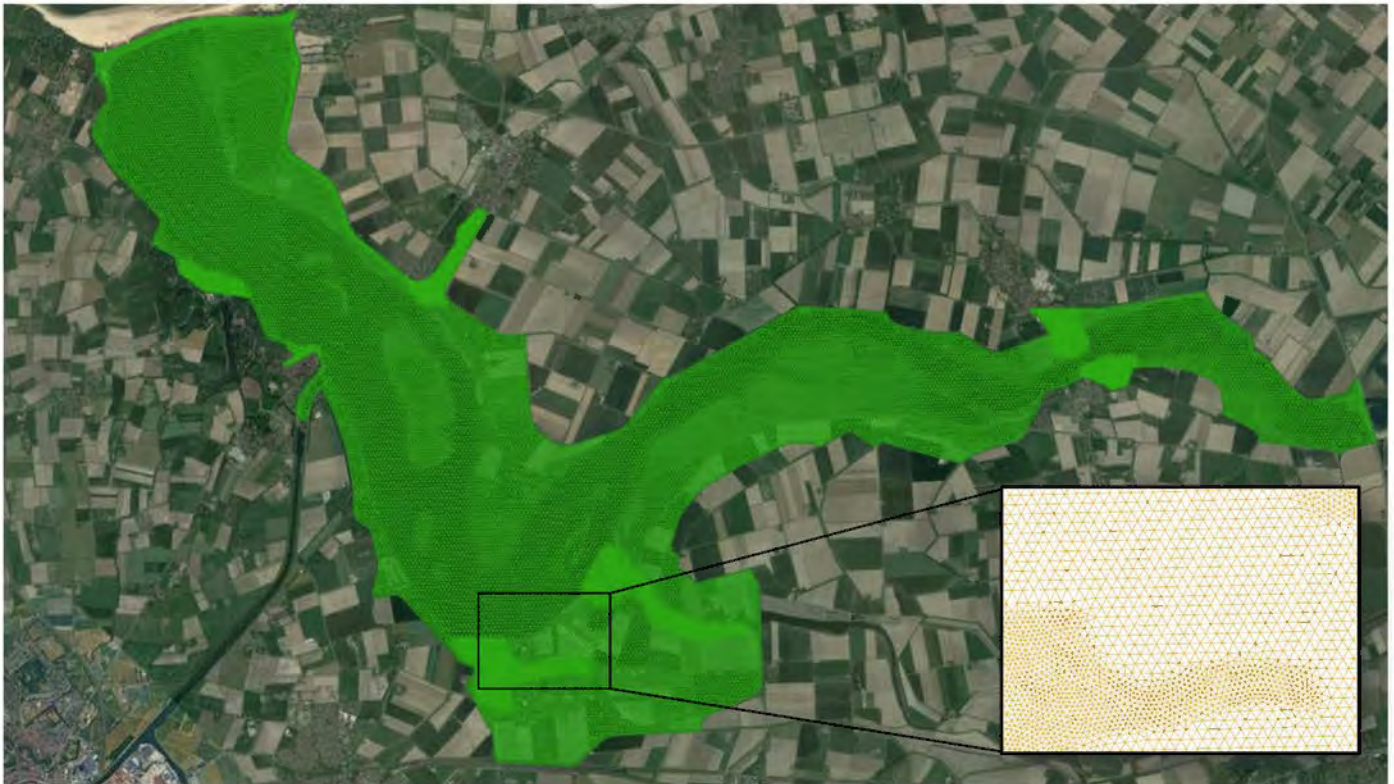
Figuur 2-2 Een detail van het rekenrooster van het officiële zesde generatie 3D D-Hydro model van het Veerse Meer.
