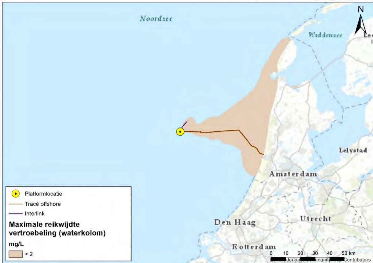
Figuur 4-13 Gebied tot waar de dieptegemiddelde slibwolk (> 2 mg/L) ten gevolge van de werkzaamheden van Hollandse Kust (west Beta) reikt (Arcadis, 2018). N.B. dit is een ouder figuur gebaseerd op oudere data vanuit Hollandse Kust (west Beta).
