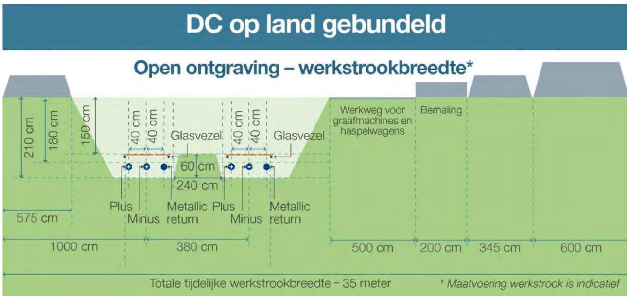
Figuur 7: Schematische weergave kabelconfiguratie open ontgraving inclusief werkterreinen op land bij parallelligging Netten op zee Nederwiek 1 en IJmuiden Ver Alpha ((TenneT 2022).
