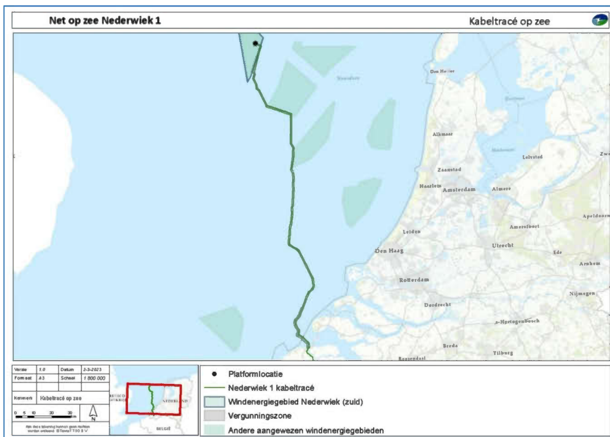
Figuur 2-2 Offshore kabeltracé en de bijbehorende onderhoudszones (corridor waarvoor vergunning wordt aangevraagd), lopend vanaf het platform Nederwiek 1 tot de Veerse Gatdam
