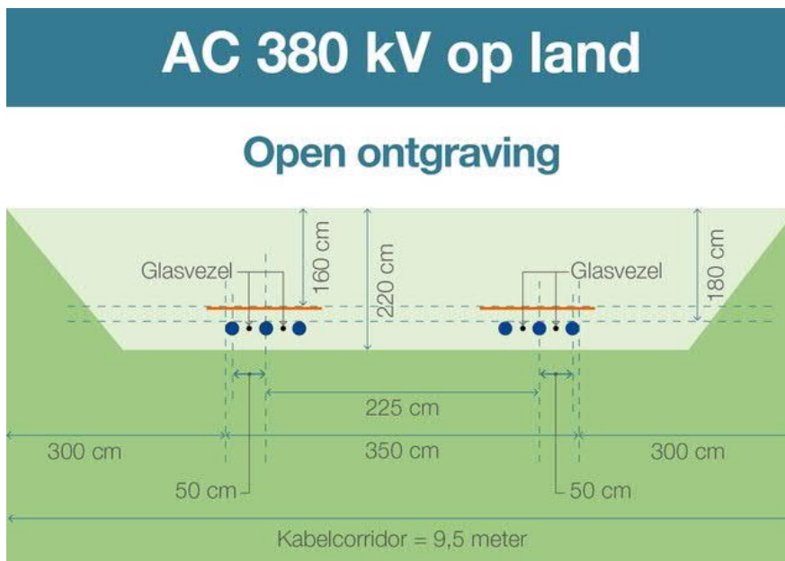
Figuur 2.6: Belemmerende strook Net op zee Nederwiek 2 (AC) bij open ontgraving
