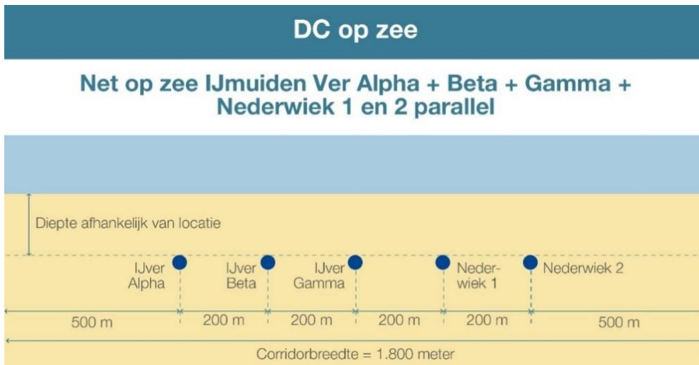
Figuur 1-11 Kabelconfiguratie Netten op zee Nederwiek 1 en 2 en Netten op zee IJmuiden Ver Alpha, Beta en Gamma
