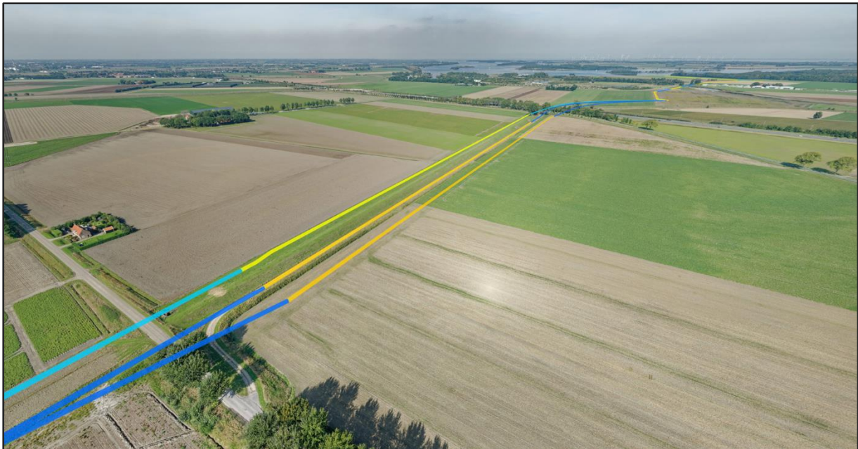
Figuur 3-6 Route kabeltracé parallel aan de Zeedijk van de Jacobapolder (Geel = kabeltracé Net op zee IJmuiden Ver Alpha, oranje = tracévarianten Net op zee Nederwiek 1).
