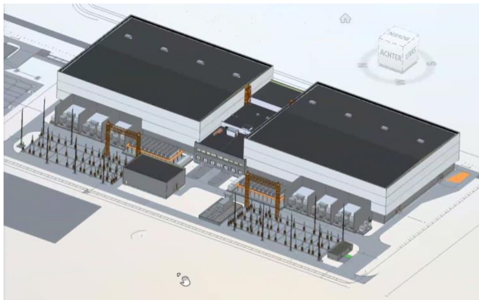
Figuur 2.3 3D impressie converterstation
