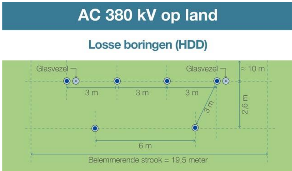
Figuur 2-23 Kabelconfiguratie AC-verbinding bij boring (HDD).
