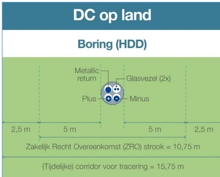
Figuur 2-27 Kabelconfiguratie boring op land Nederwiek 1.
