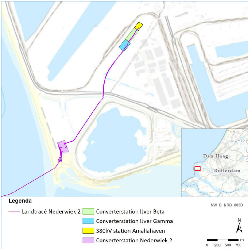
Figuur 2-14 Kabeltracé op land vanaf aanlanding (linksonder) tot converterstation en vervolgens naar het 380kV-hoogspanningsstation.
