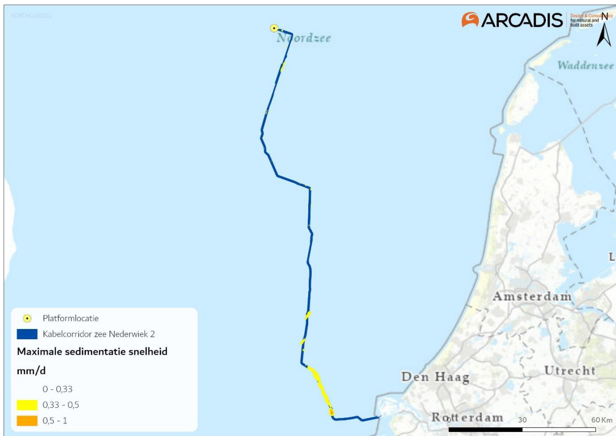
Figuur 3-2 Het areaal waar sedimentatie van boven de 0,33 mg/dag optreedt door de voorgenoemde werkzaamheden van de aanleg van een (2x2)-kabelconfiguratie.
