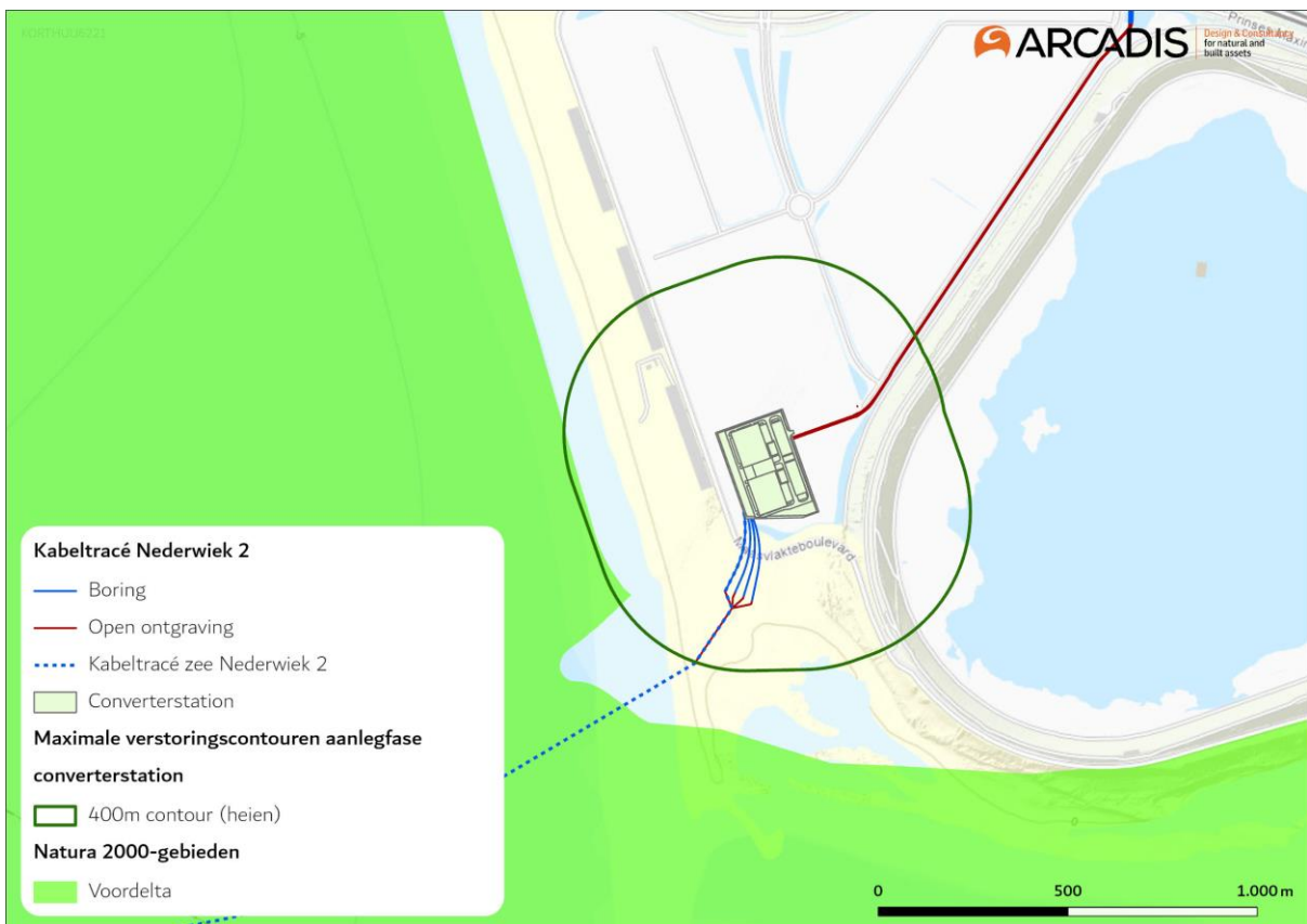
Figuur 3-12 Contouren van verstoringsafstanden als gevolg van heigeluid op land rond het converterstation.
