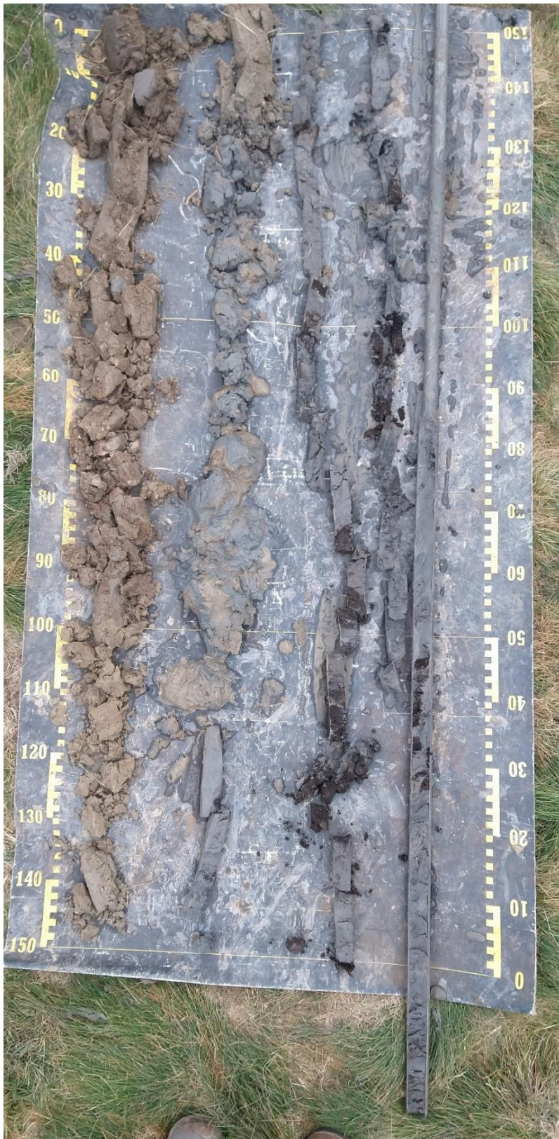
Figuur 14: Foto van boring 1004001. De boring is verdeeld in 4 kolommen van anderhalve meter die van links naar recht en van boven naar beneden gelezen moeten worden.
