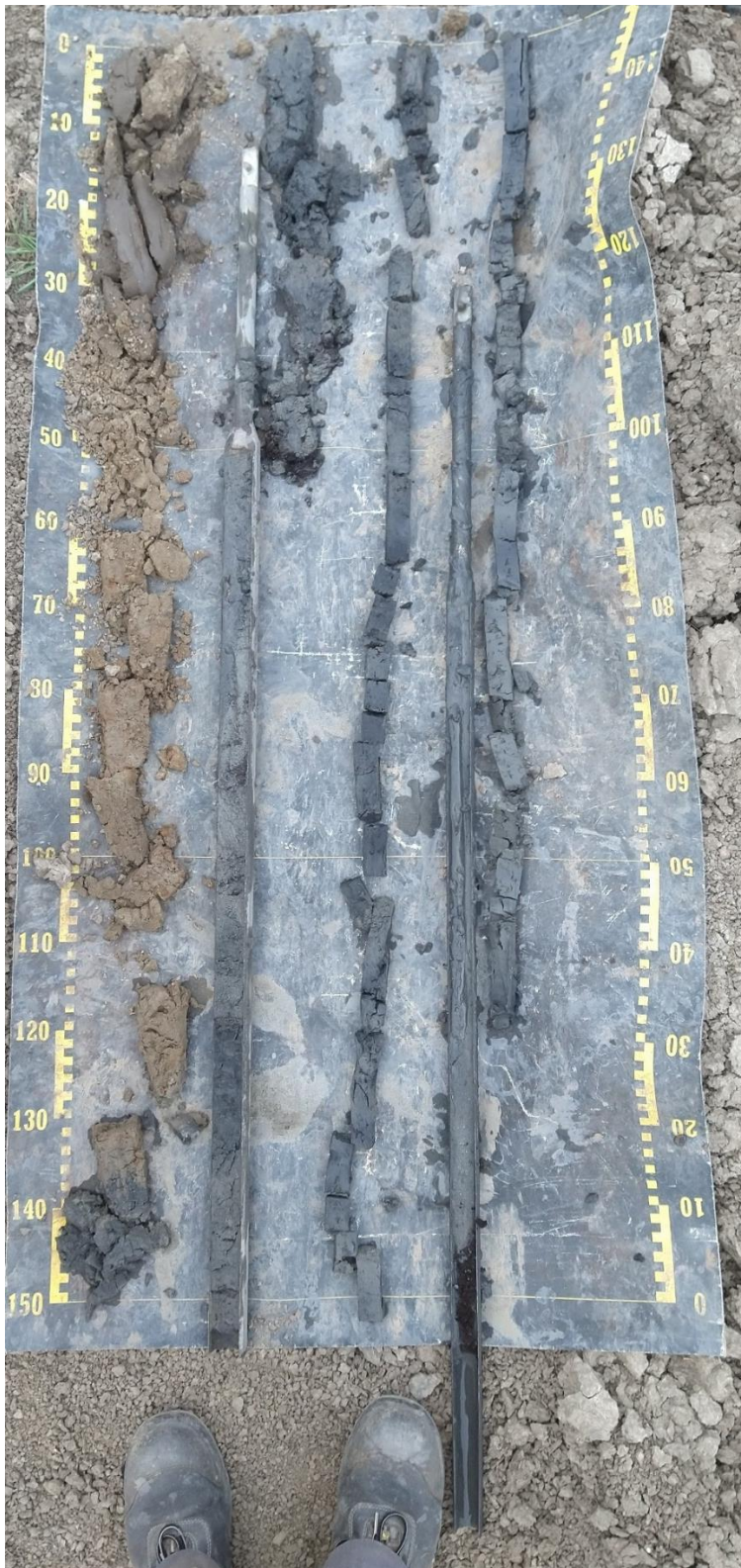
Figuur 22: Foto van boring 1006001. De boring is verdeeld in 4 kolommen van anderhalve meter die van links naar recht en van boven naar beneden gelezen moeten worden.
