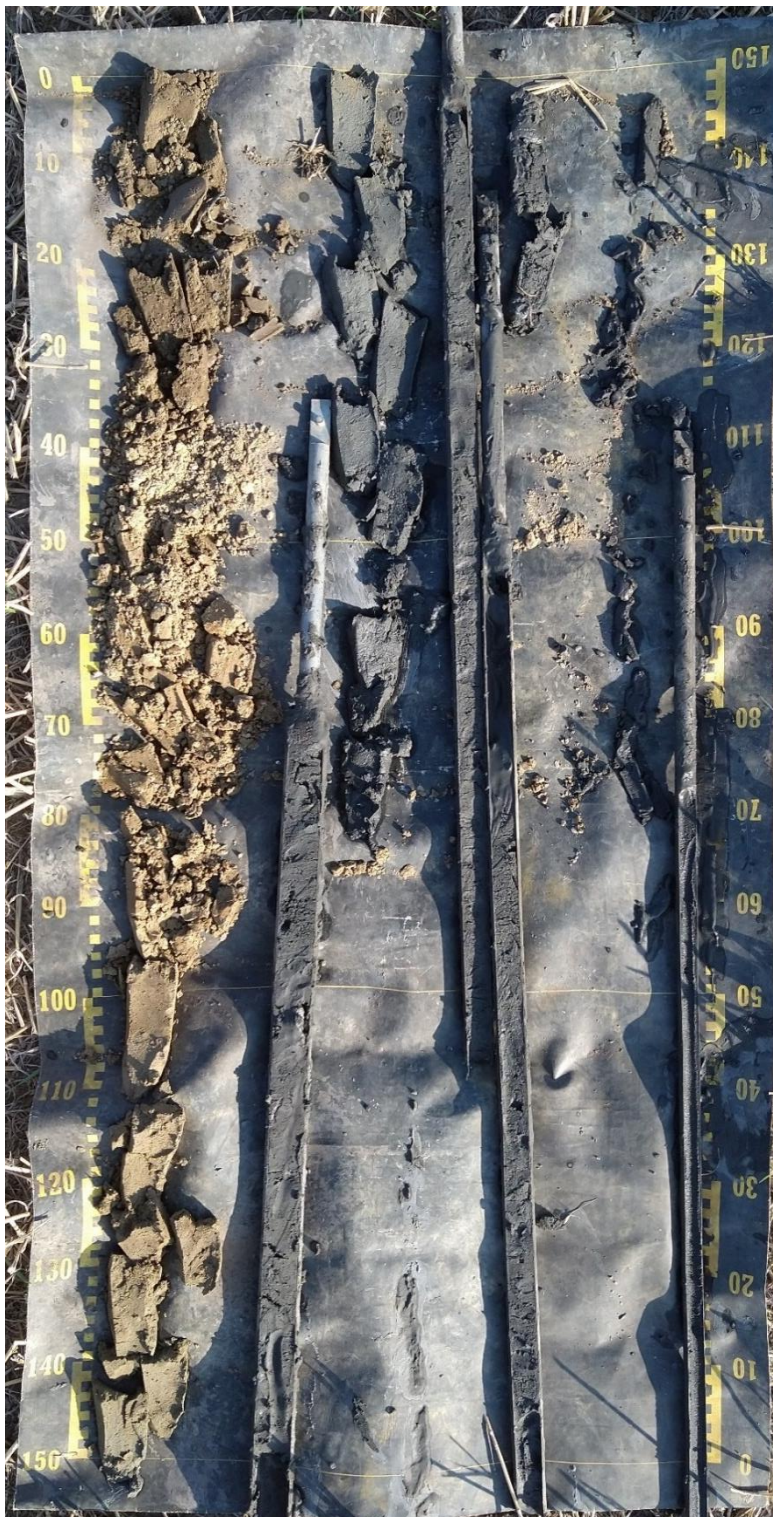
Figuur 45: Foto van boring 1012001. De uitgelegde boorstalen lopen in diepte van boven naar beneden en van links naar rechts.
