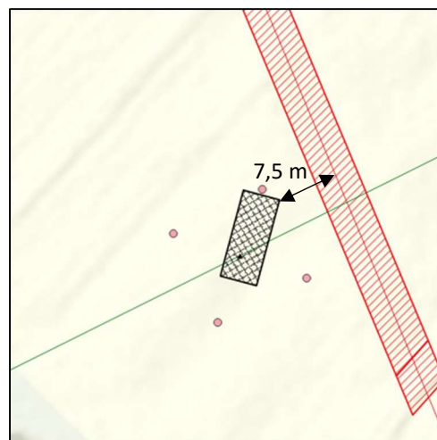
Figuur 4-4: Scenario 2 - Positie funderingsmachine (aangegeven in zwart) i.r.t. rioolleiding (rode lijn).
