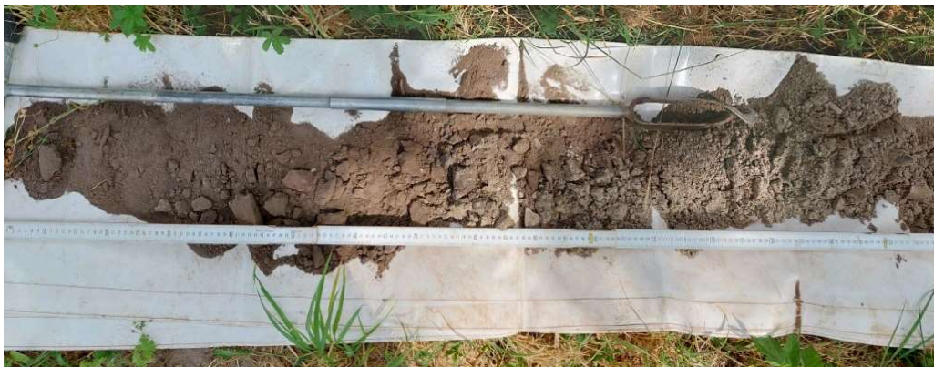
Profielboring op de rand van de kroonprojectie bij boom 1: Op 1,1 m beneden maaiveld is de bodem vochtig, sterk verdicht en is roest aanwezig. De gehele groeiplaats is humusarm.
