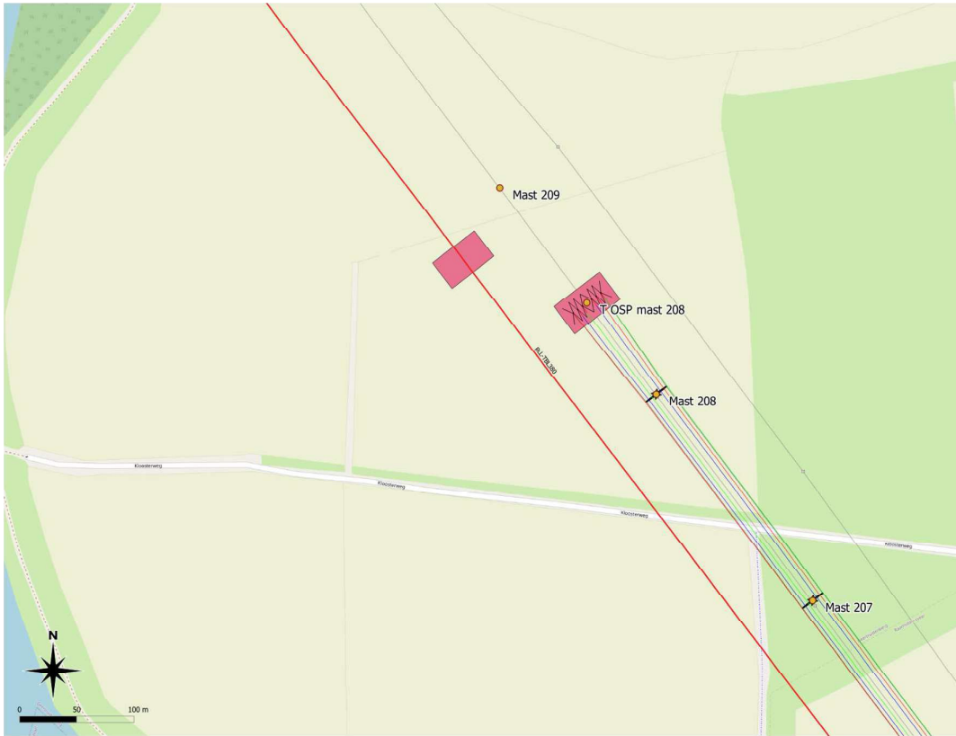
Figuur 10 Tijdelijke 150 kV-verbinding nabij het Noordergat te Geertruidenberg (TOSP 208)
