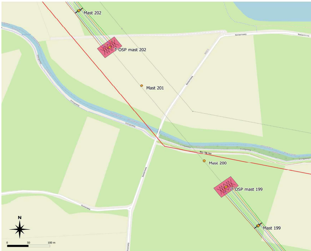
Figuur 9 Tijdelijke 150 kV-verbinding het Kromgat (gemeentegrens Geertruidenberg en Oosterhout) (TOSP 199 en TOSP 202)
