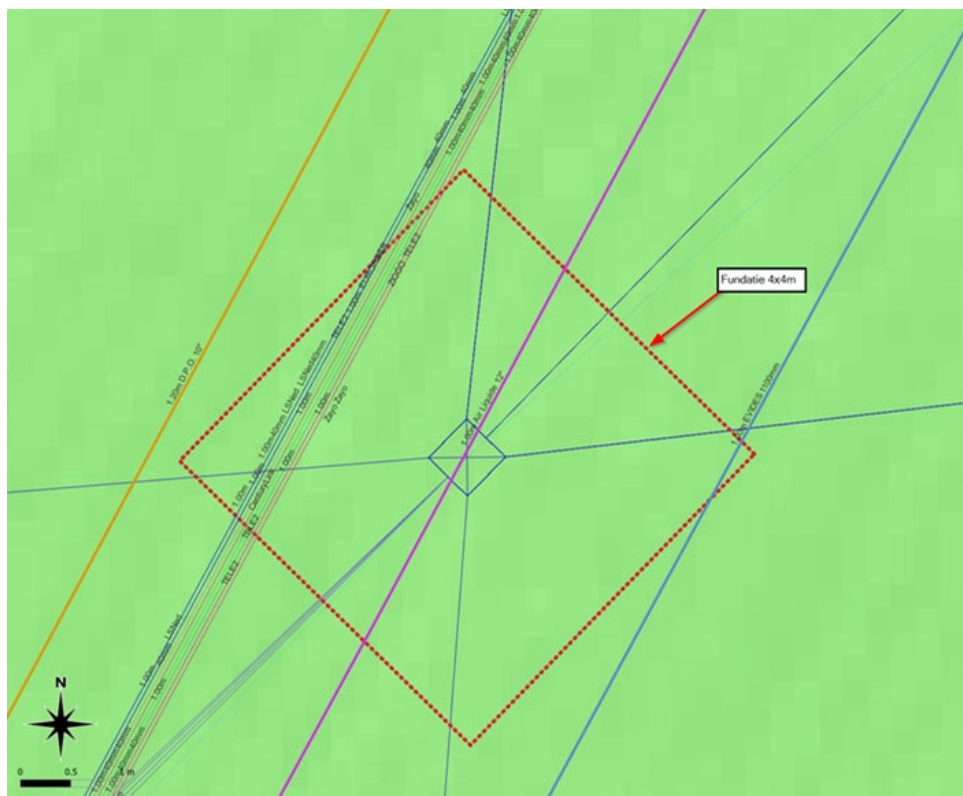
Figuur 7: Fundatie van tijdelijke mast TM-68-1.
