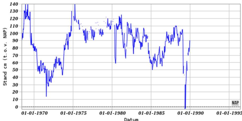
Figuur 12 Grondwaterstand in het eerste watervoerende pakket, B30H0096-002 uit Dinoloket, filter op NAP -10,5 tot -11,5 m
