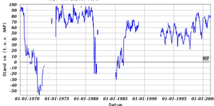
Figuur 10 Grondwaterstand in het eerste watervoerende pakket, B30H0125-002 uit Dinoloket, filter op NAP -11,9 tot -13,96 m
