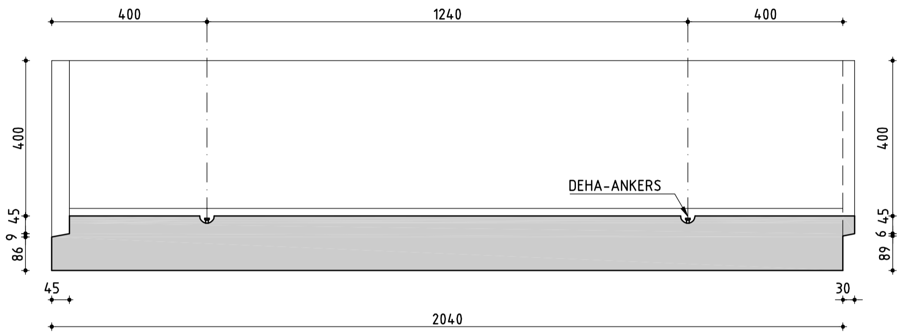
STANDAARDGOOT SCHAAL 1:10 Lang 2040 massa: 0,8 ton
