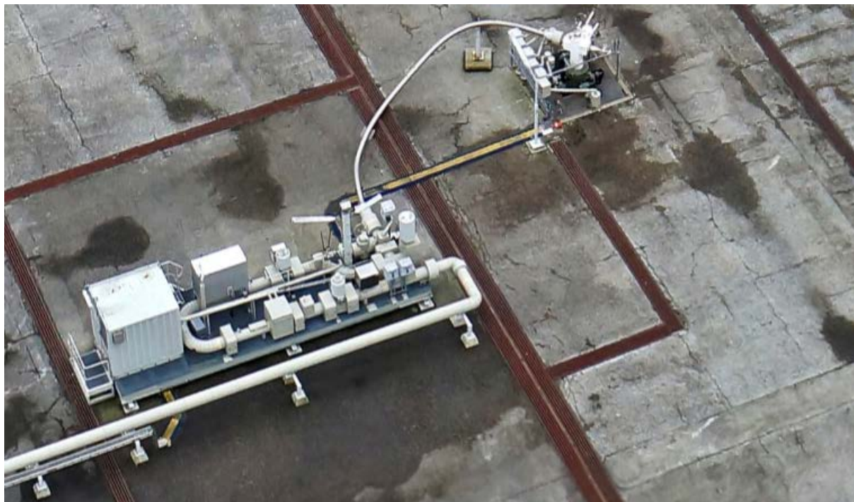
Voorbeeld van een productie-eenheid met flexibele aansluiting op de gasproductieput.
