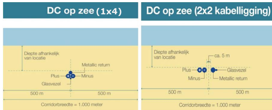
Figuur 2.2: Corridorbreedte van één kabeltracé op zee (met links de 1x4 kabelconfiguratie en rechts de 2x2 kabelconfiguratie)
