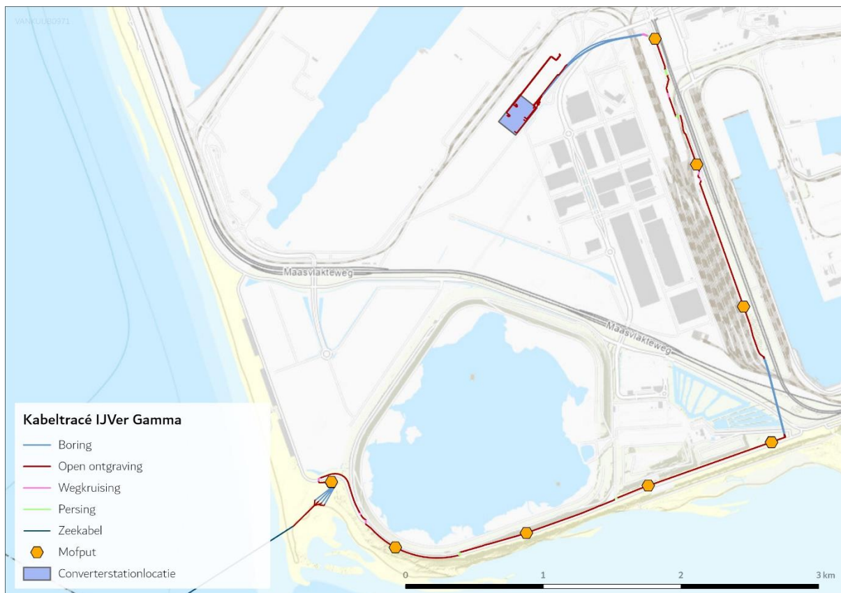
Figuur 28 Verbindingsmof en mofputten op land.
