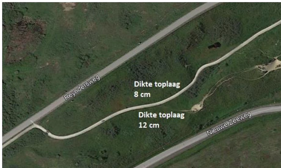
Afbeelding 27: Impressie dikte te ontgraven toplaag WKT2.
