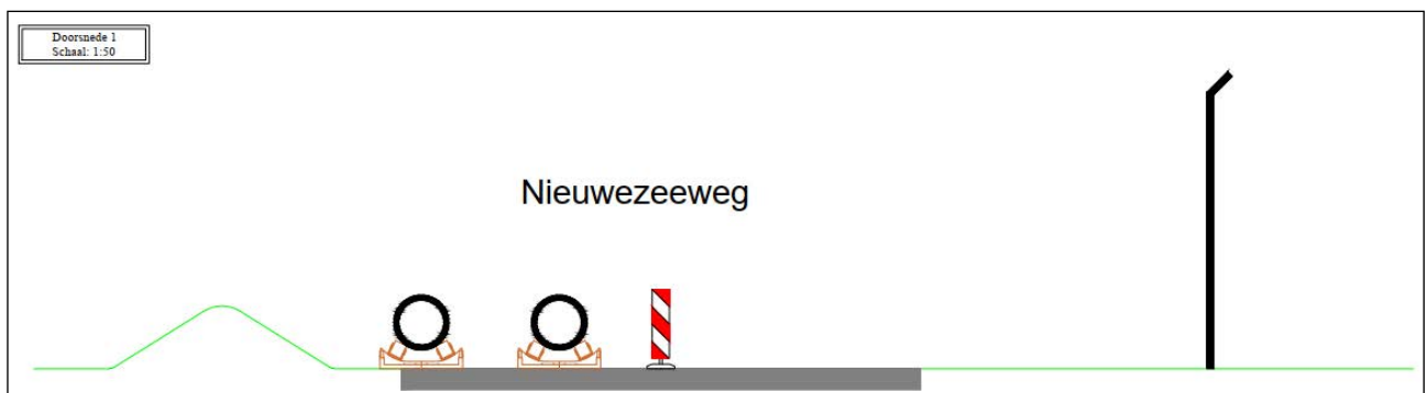
Afbeelding 30: Doorsnede van de las- en uitleglocatie ter plaatse van de Nieuwe Zeeweg: halve rijbaanafzetting.
