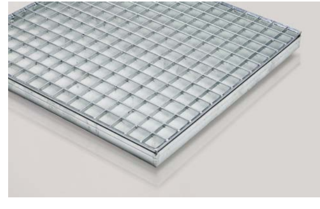
Persroosters, Draagtaaf 30x3, vulstaaf 10x2 Maaswijdte draag- en vulstaven 33,33mm h.o.h.
