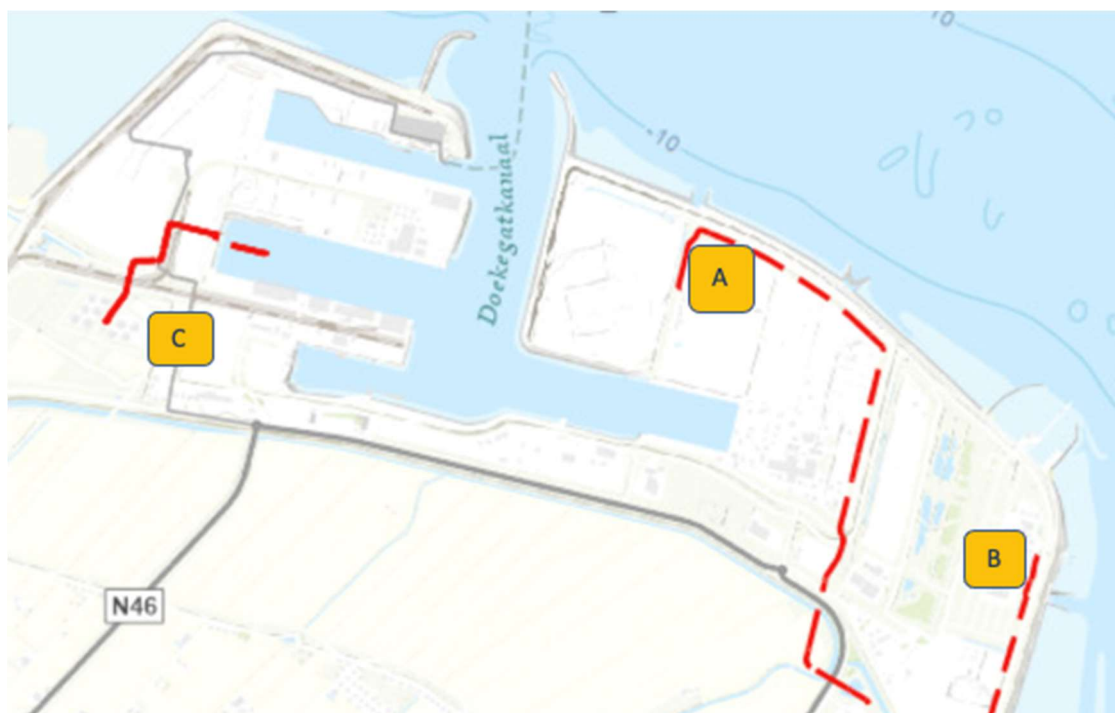
Figuur 10. Ondergrondse buisleidingen (bron: Risicokaart.nl)
