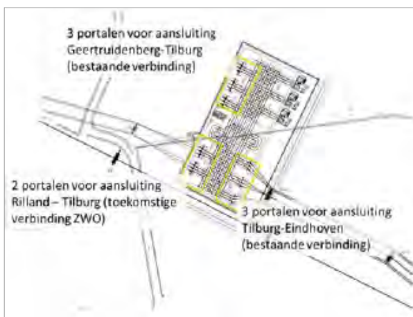
Figuur 2.4 Aansluitportalen 380 kV-hoogspanningsstation
