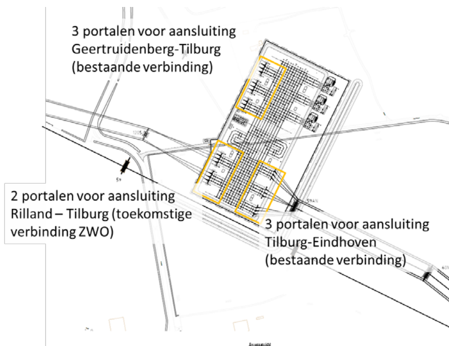
Figuur 3. Aansluitportalen 380 kV station
