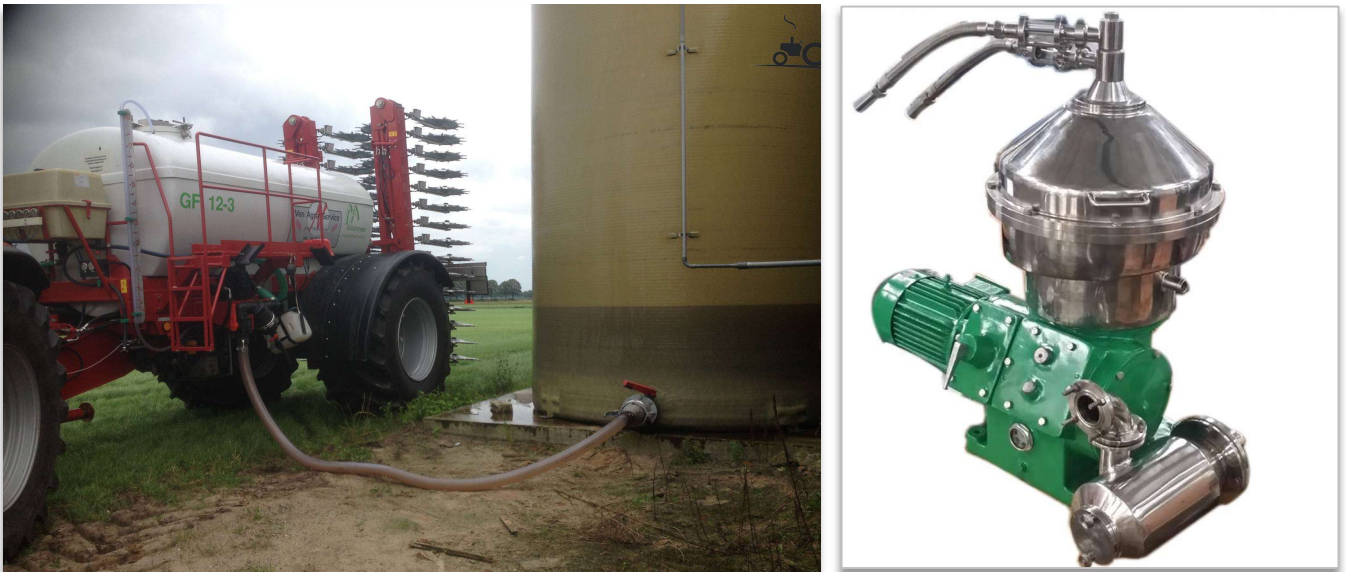
Figuur 11 Vullen van een mesttank met (geconcentreerde) dunne fractie vanuit opslagtank (links) en een innovatieve scheidingstechnologie (rechts).
