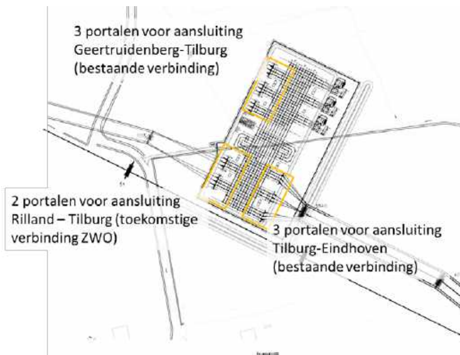
Figuur 3. Aansluitportalen 380 kV station
