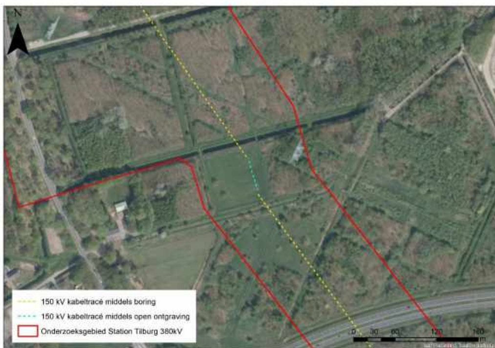
Figuur 5: Luchtfoto met derde open ontgraving van 150kV kabeltracé.
