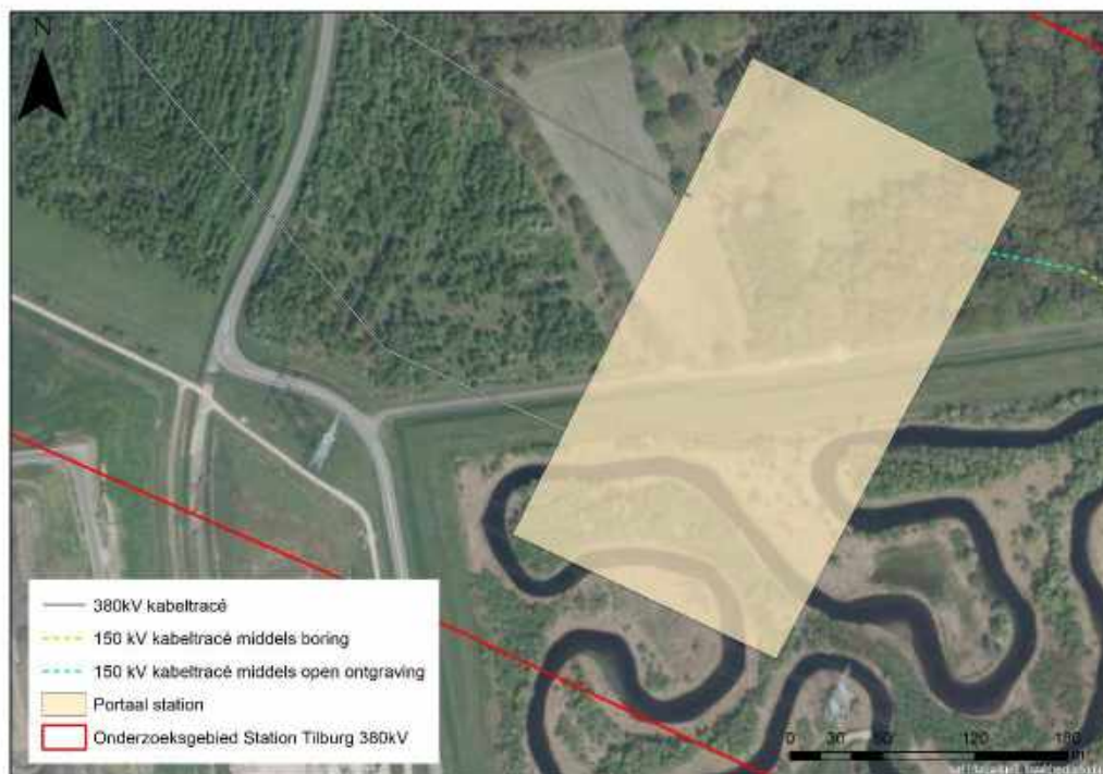
Figuur 3: Luchtfoto met locatie 380kV hoogspanningsstation, aansluiting op 380kV kabeltracé en eerste open ontgraving van 150kV kabeltracé.
