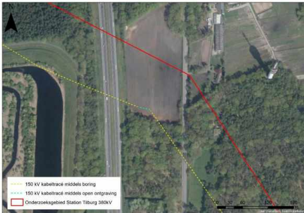
Figuur 4: Luchtfoto met tweede open ontgraving van 150kV kabeltracé.
