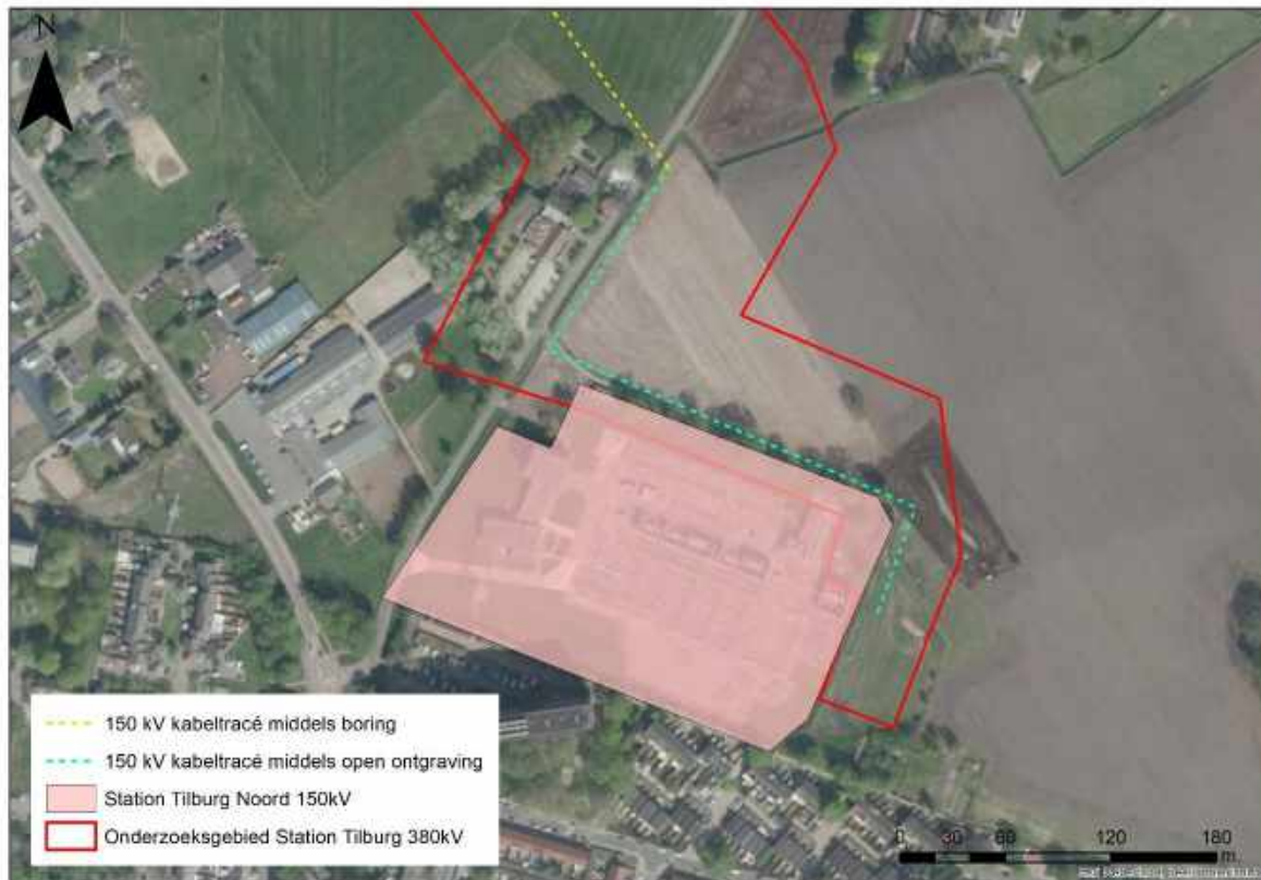
Figuur 7: Luchtfoto met locatie Station Tilburg Noord en de tweede open ontgraving van 150kV kabeltracé.
