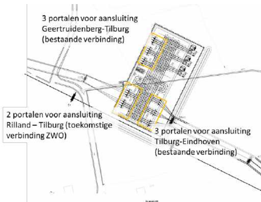
Figuur 3. Aansluitportalen 380 kV station
