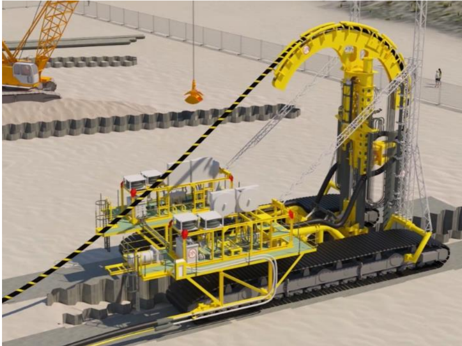
Figuur 4-15: Moonfish (vorig model) start met de kabel op diepte in de cofferdam
