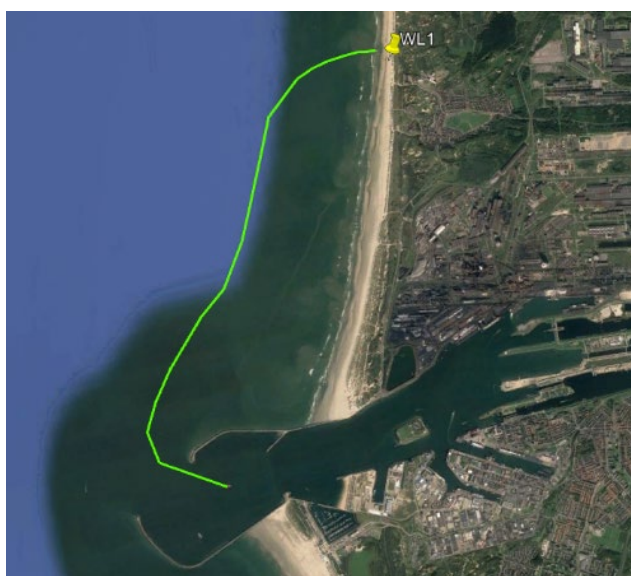
Figuur 5-1: Optie 3 - Opbouw drijvende leiding haven van IJmuiden, transport over zee
