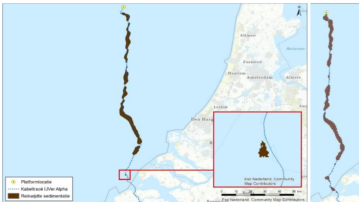
Figuur 3-5 Gebieden waar de sedimentatie per dag boven de grens van 1cm per maand (0,33mm/dag) uitkomt voor de (1x4)-kabelconfiguratie (links) en de (2x2)-kabelconfiguratie (rechts).
