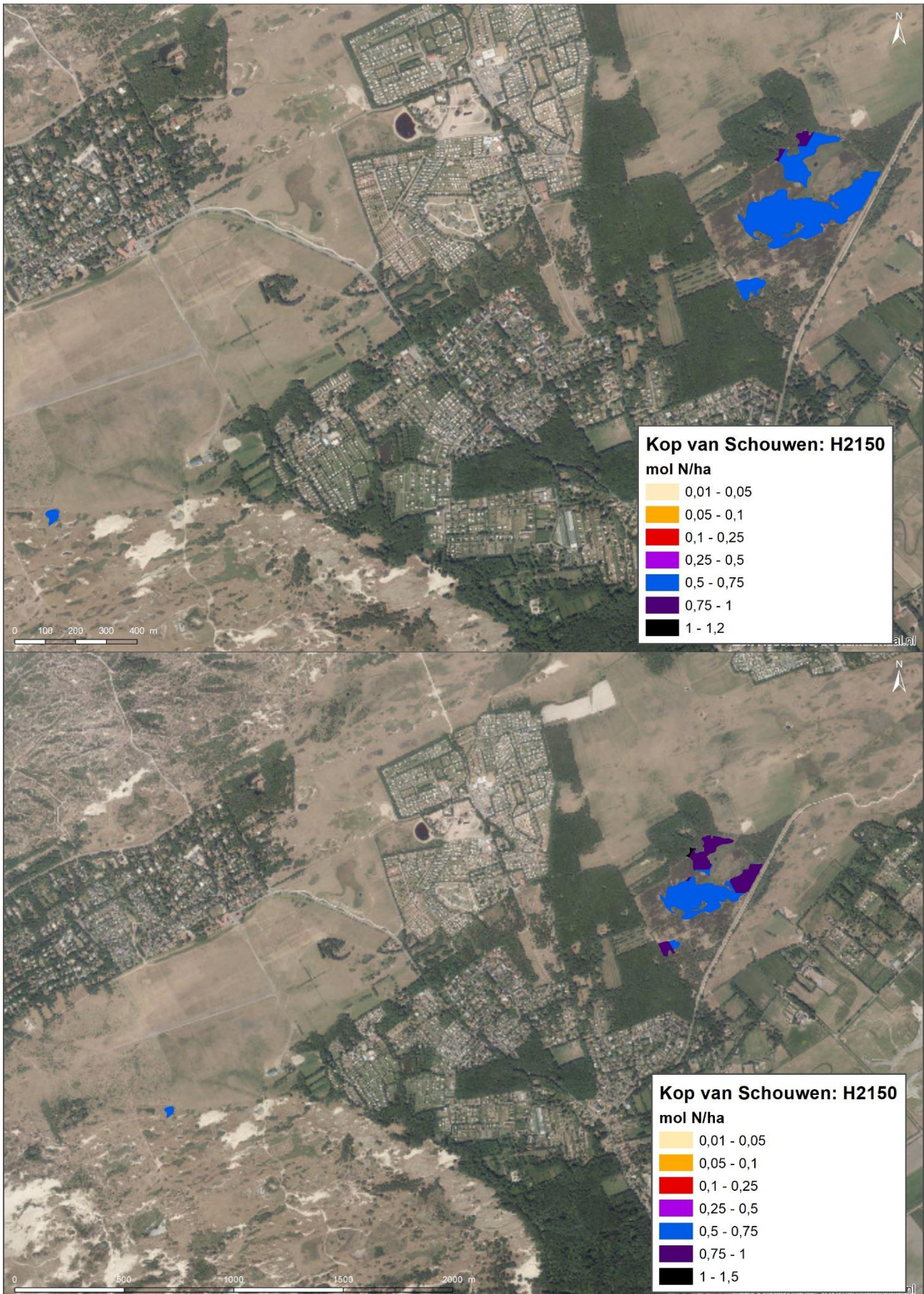
Figuur 18 Toename van stikstofdepositie in Natura 2000-gebied Kop van Schouwen als gevolg van de aanleg van Net op zee IJmuiden Ver Alpha (boven 1x4 kabelconfiguratie, onder 2x2 kabelconfiguratie) op locaties met habitattypen H2150 Duinheiden met struikheide waar een overschrijding van de KDW optreedt.
