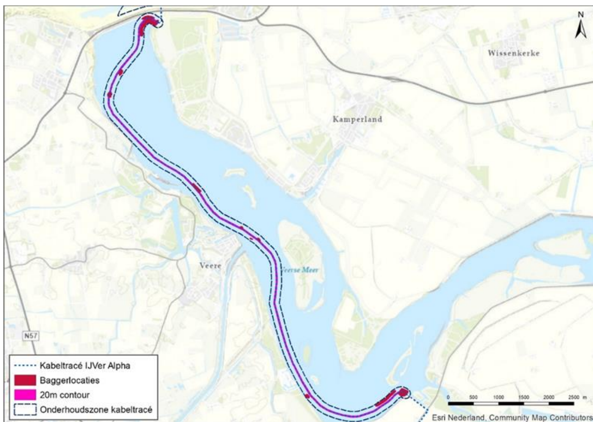
Figuur 45 Baggerlocaties in het Veerse Meer, op de ondiepe delen van het VKA-tracé
