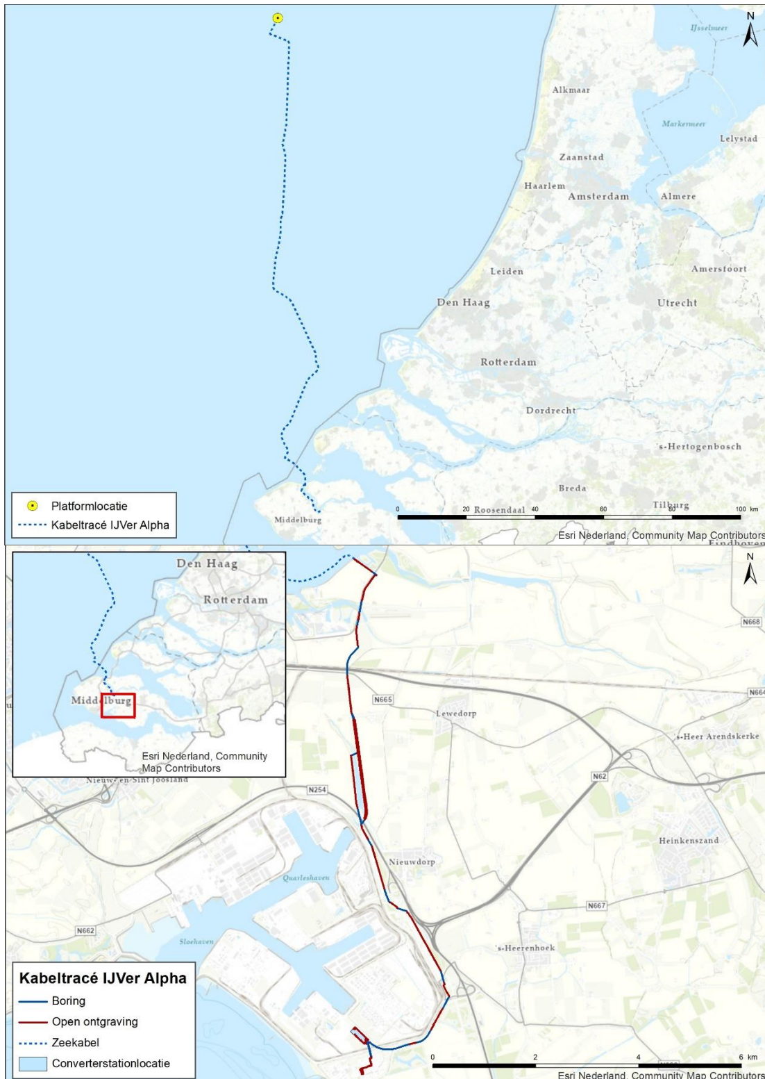
Figuur 2 Boven: overzichtskaart VKA-tracé Net op zee IJmuiden Ver Alpha op zee inclusief locatie van het platform. Onder: ingezoomde kaart van het VKA-tracé inclusief werkterrein, in/uitredepunten en het converterstation
