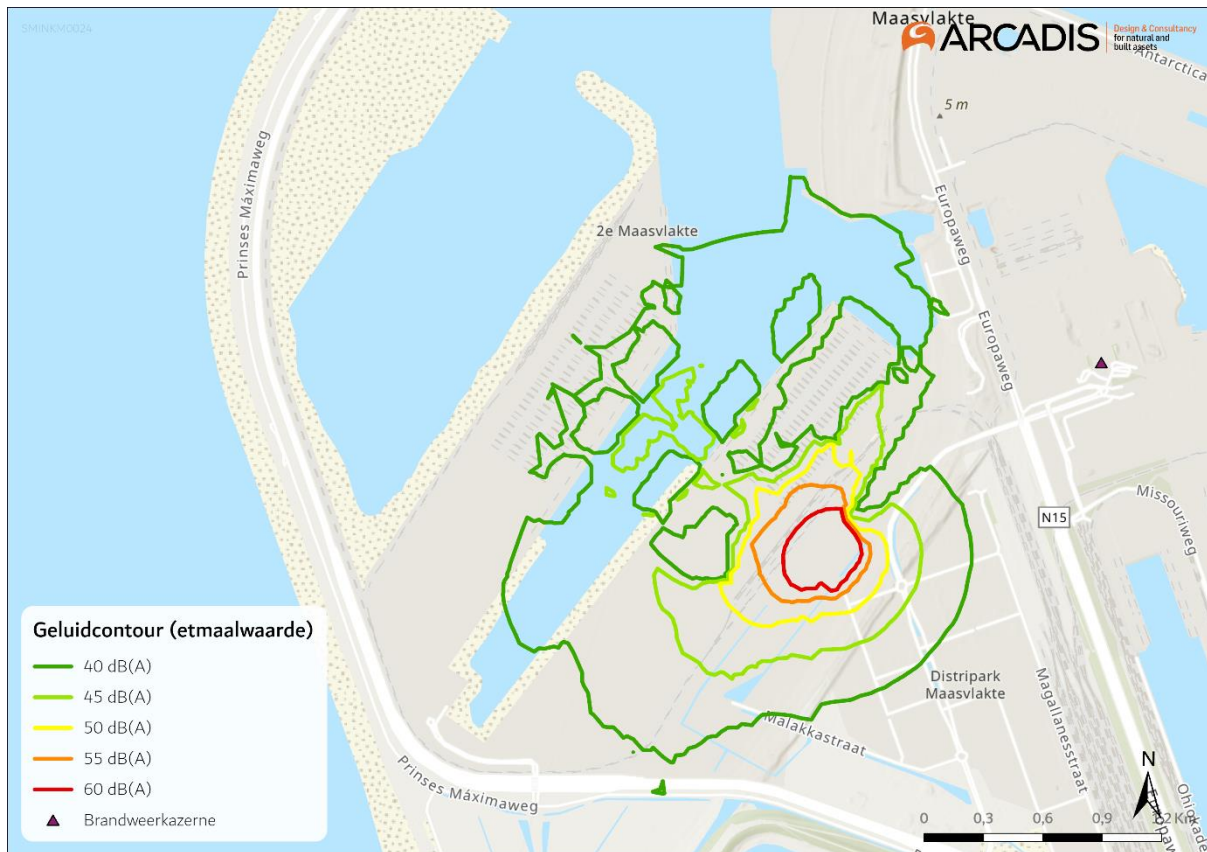
Figuur 9-14 Geluidcontouren ( L_{etmaal} ) vanwege het converterstation
