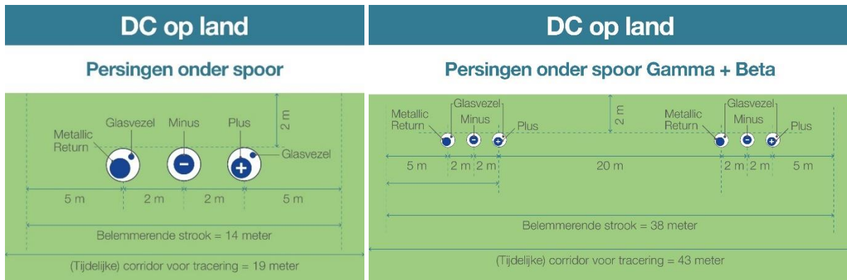
Figuur 1-23 Ruimtebeslag en ligging kabels bij persing onder spoor, zonder (links) en met (rechts) parallellegging Gamma en Beta
