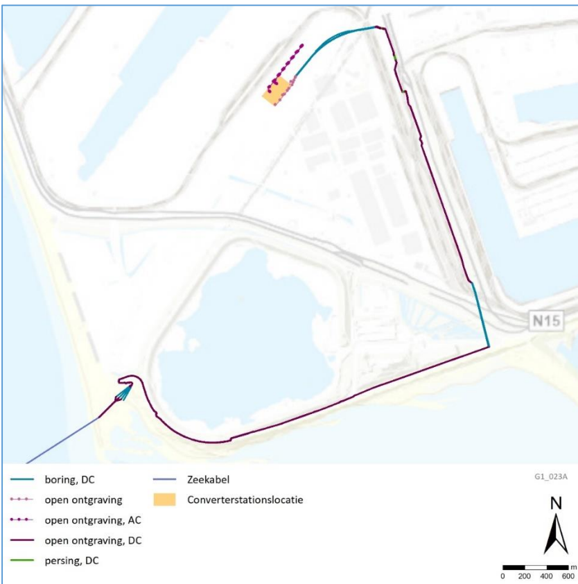
Figuur 1-25 Overzicht open ontgravingen en boringen (HDD en persboringen) op de Maasvlakte
