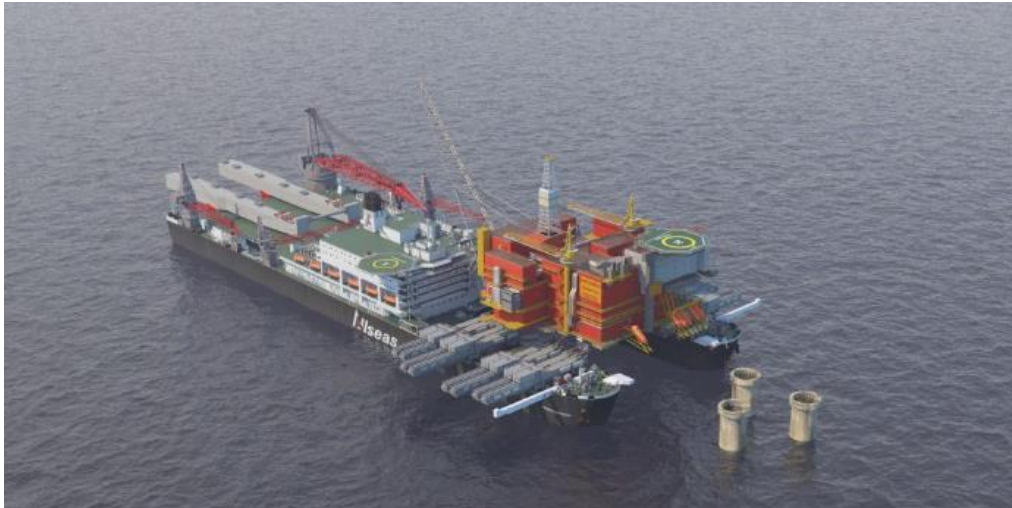
Figuur 1-5 Bovenbouw van onderen optillen m.b.v. een catamaranschip (hier: "Pioneering Spirit")
