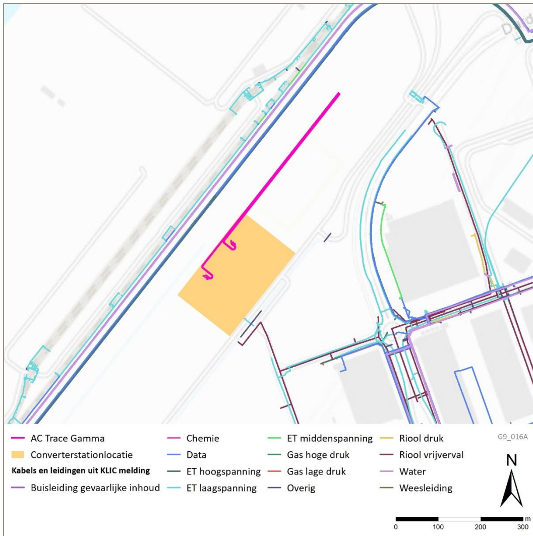
Figuur 9-16 AC kabeltracé en kabels en leidingen
