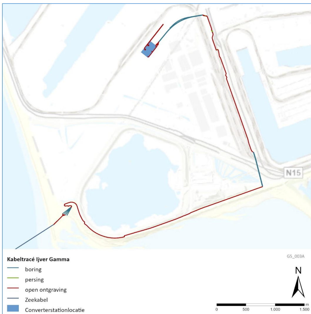
Figuur 5-3 Ligging 525kV-gelijkstroomkabels op land.
