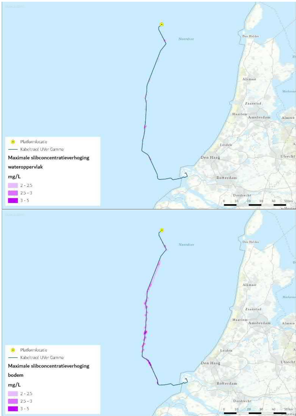
Figuur 2 Gebied tot waar de slibwolk (> 2 mg/L) aan het wateroppervlak (figuur boven) en op de bodem (figuur onder) maximaal reikt ten gevolge van de werkzaamheden van de aanleg van een (2x2)-kabelconfiguratie (de worst-case).
