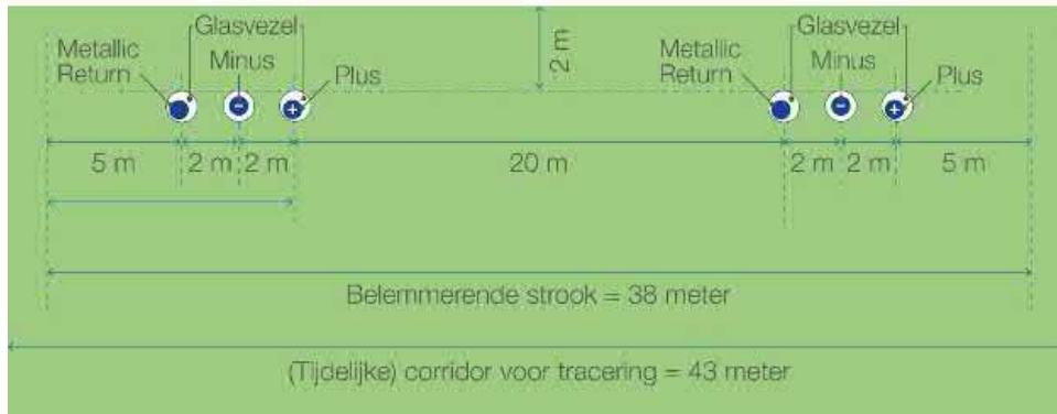
Figuur 27 De kabelconfiguratie en werkstroombreedte bij persing onder het spoor voor Net op zee IJmuiden Ver Gamma en Beta.
