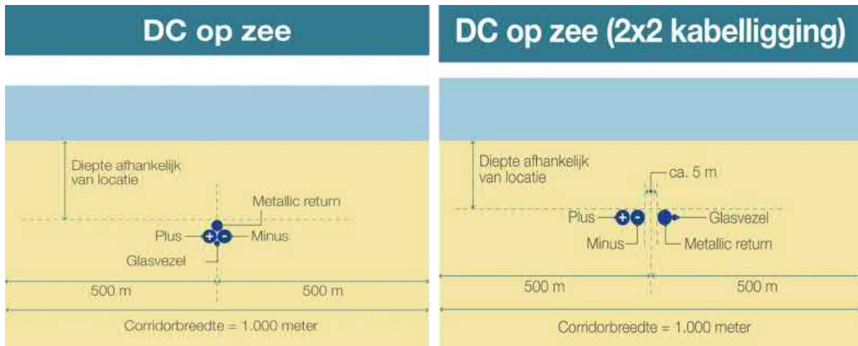
Figuur 13 (1x4)-kabelconfiguratie op zee (links) en (2x2)-kabelconfiguratie op zee (rechts)
