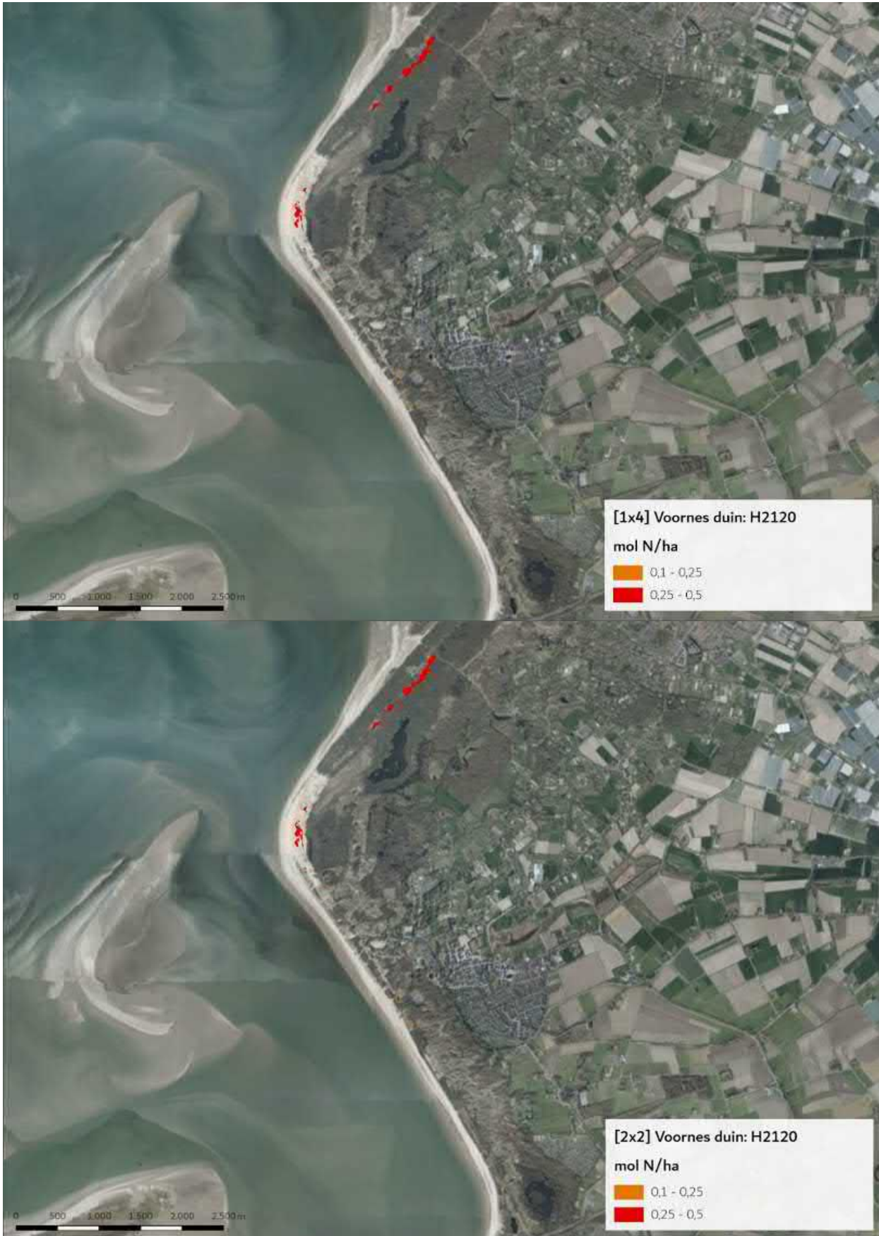
Figuur 5-2 Toename van stikstofdepositie in Natura 2000-gebied Voornes Duin als gevolg van de aanleg van Net op zee IJmuiden Ver Gamma op locaties met habitatype H2120 Witte Duinen waar een overschrijding van de KDW optreedt.
