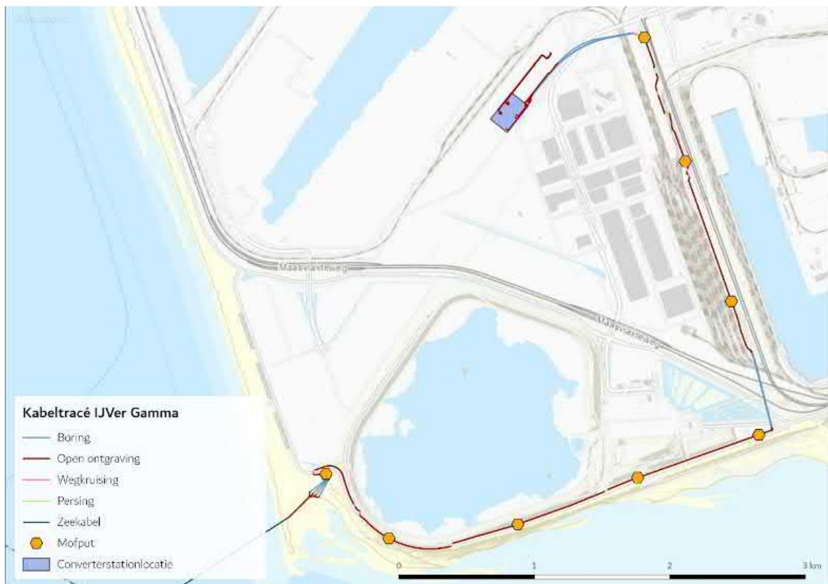
Figuur 28 Verbindingsmof en mofputten op land.
