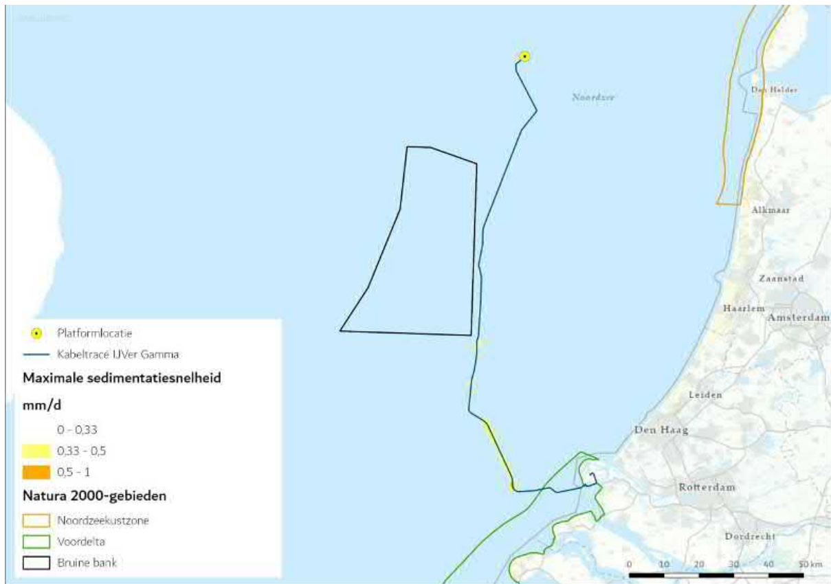
Figuur 3 Het areaal waar sedimentatie van boven de 0,33 mg/dag optreedt door de voorgenomen werkzaamheden van de aanleg van een (2x2)-kabelconfiguratie
