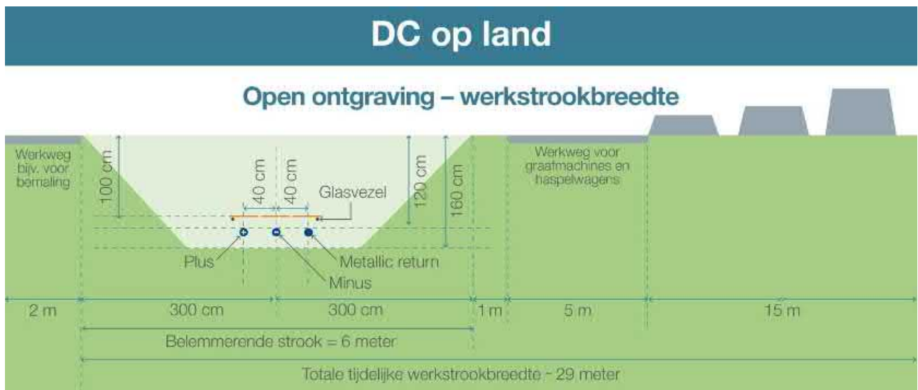
Figuur 5. Open ontgraving met werkstrookbreedte.
