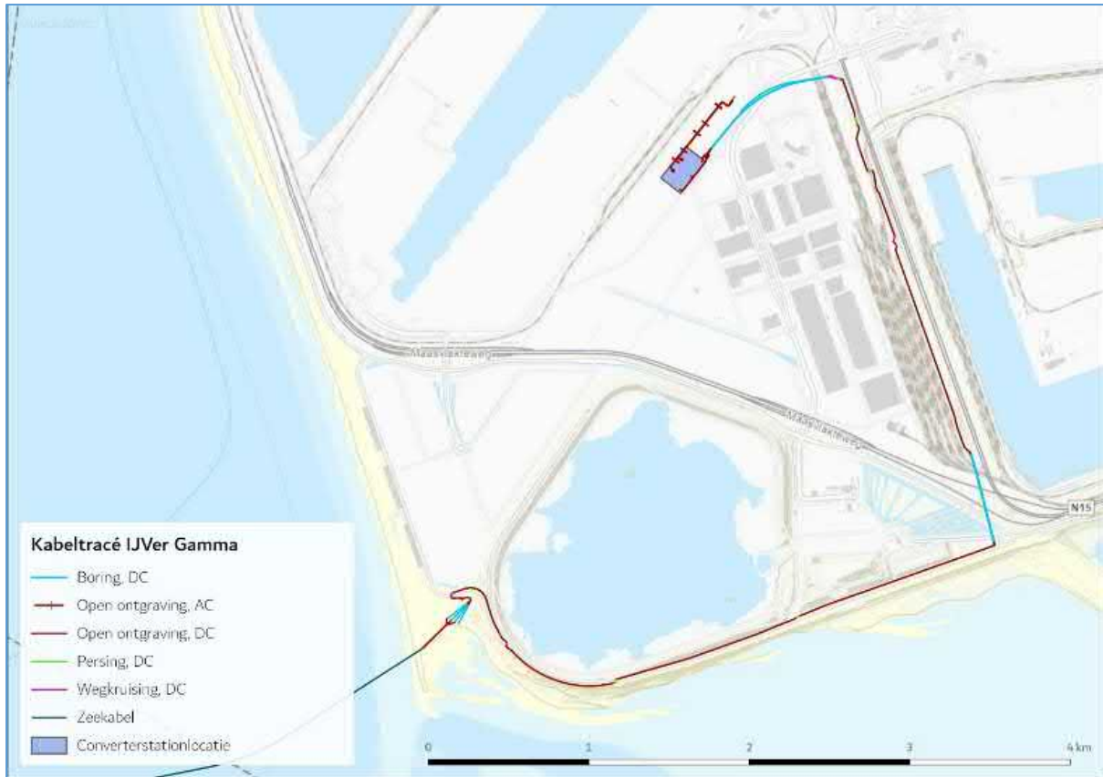
Figuur 2 Ingezoomde kaart van het voorkeurstracé op land inclusief in/uittredepunten, open ontgravingen, boringen en het converterstation.
