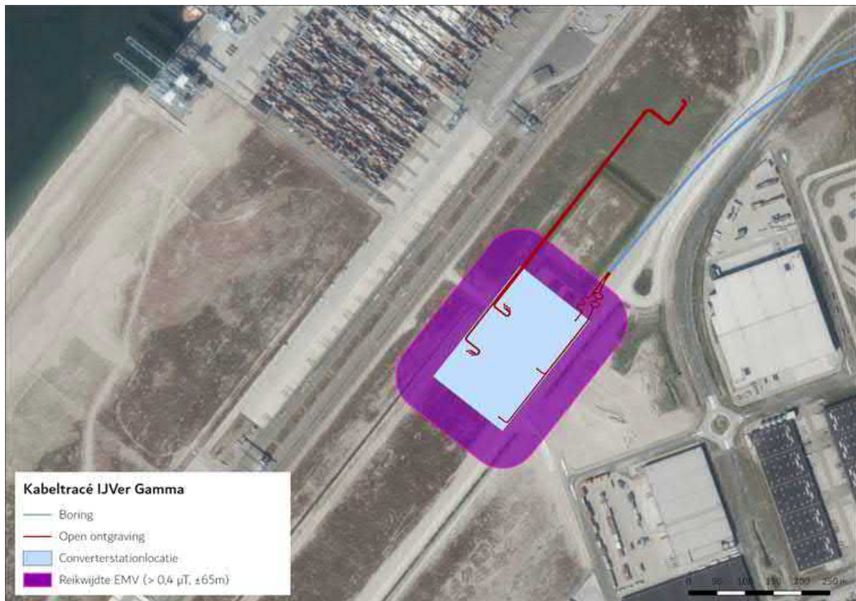
Figuur 13 Elektromagnetische veldzones rondom het converterstation Gamma (Van Essen, 2021c).
