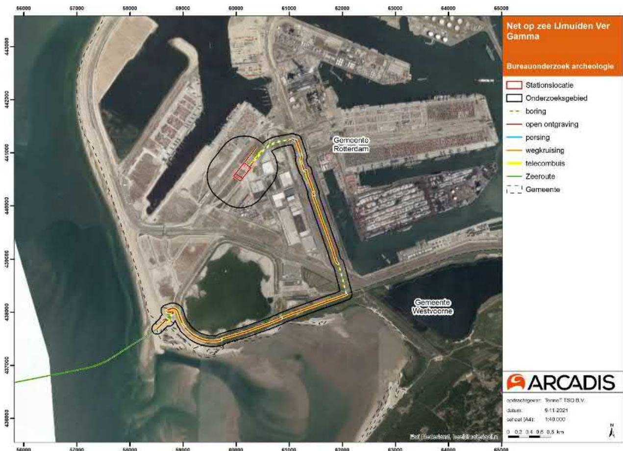
Figuur 1: Plangebied met daarop de aanlanding en de kabels van IJmuiden Ver Gamma op land.
