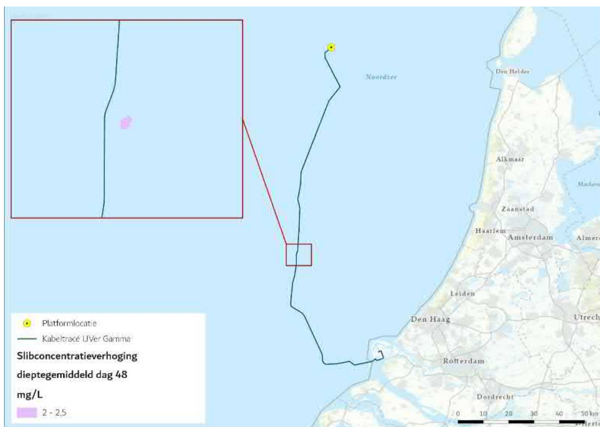
Figuur 66 Vertroebeling van dieptegemiddelde op dag 48, de dag met de grootste toename van slib in de waterkolom
