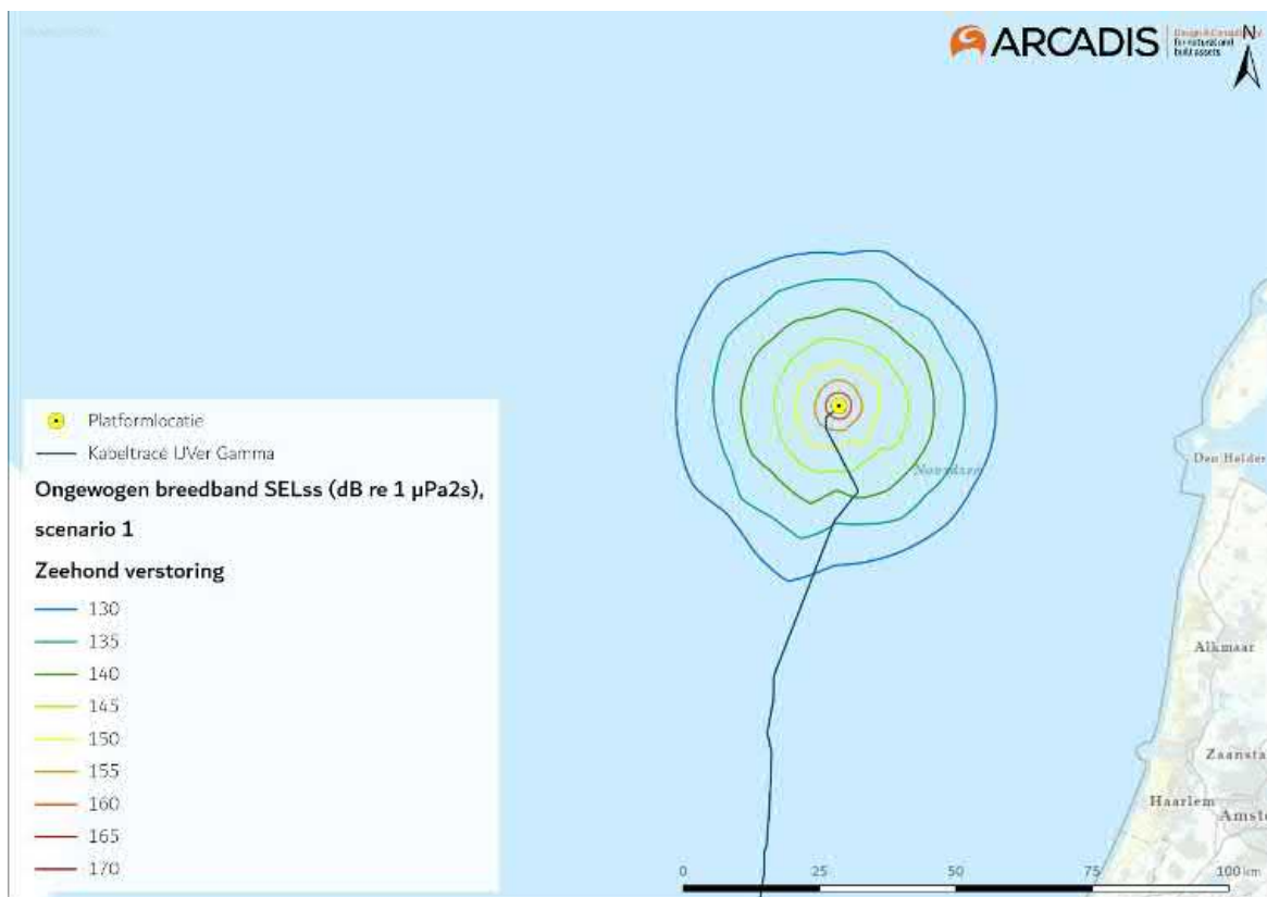
Figuur 7 Reikwijdte van onderwaterverstoring als gevolg van impuls-onderwatergeluid voor het heien van de fundering van het platform Net op zee IJmuiden, voor bruinvissen (boven) en zeehonden (onder)
