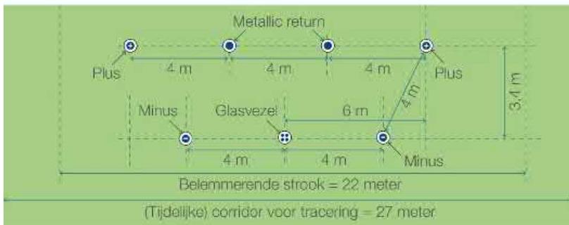
Figuur 25 De kabelconfiguratie en werkstroombreedte bij boring (HDD) van Net op zee IJmuiden Ver Gamma en Beta.
