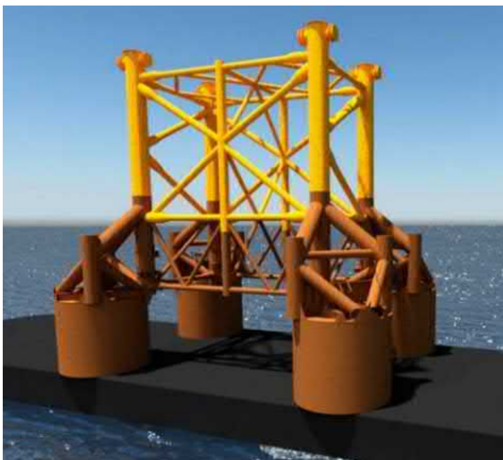
Figuur 9 Impressie van een jacket met suction buckets
