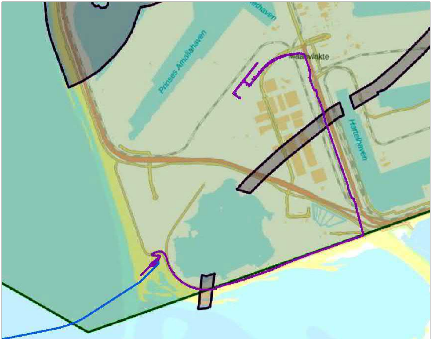
Figuur 2-18 Aanlanding, tracé op land en converterstation locaties Net op zee IJmuiden Ver Gamma en Beta en het 380kV-station Amaliahaven.
