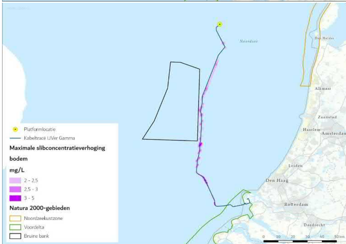
Figuur 2 Gebied tot waar de slibwolk (> 2 mg/L) aan het wateroppervlak (figuur boven) en op de bodem (figuur onder) maximaal reikt ten gevolge van de werkzaamheden van de aanleg van een (2x2)-kabelconfiguratie
