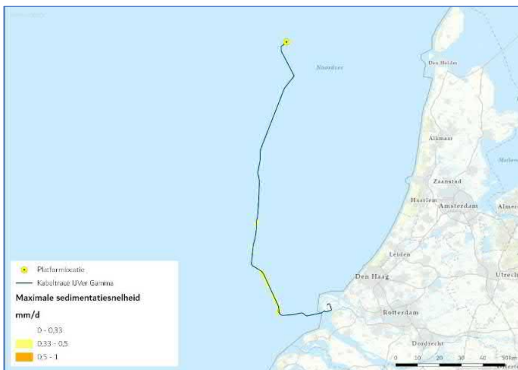
Figuur 19 Het areaal waar sedimentatie van boven de 0,33 mm/dag optreedt door de voorgenoemde werkzaamheden
