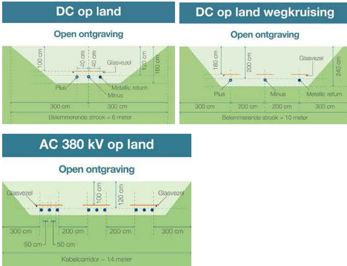
Figuur 4. Open ontgraving DC op land (boven) en AC op land (onder).
