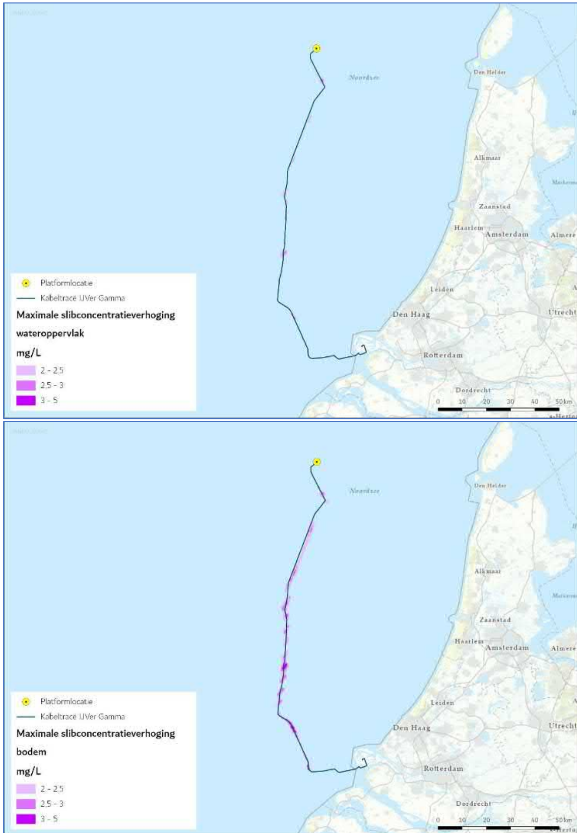
Figuur 2 Gebied tot waar de slibwolk (> 2 mg/L) aan het wateroppervlak (figuur boven) en boven de bodem (figuur onder) maximaal reikt ten gevolge van de werkzaamheden van de aanleg van een (2x2)-kabelconfiguratie
