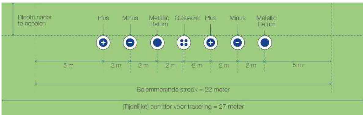
Figuur 26 De kabelconfiguratie en werkstroombreedte bij persing van het landtracé onder een weg voor Net op zee IJmuiden Ver Gamma en Beta.
