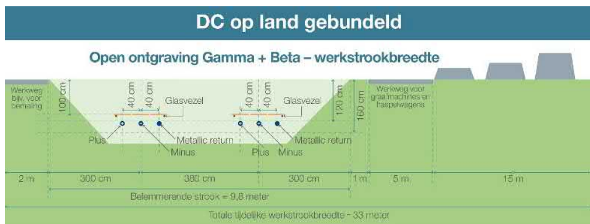
Figuur 22 De kabelconfiguratie bij open ontgraving van parallel gelegen delen van Net op zee IJmuiden Ver Gamma en Beta.
