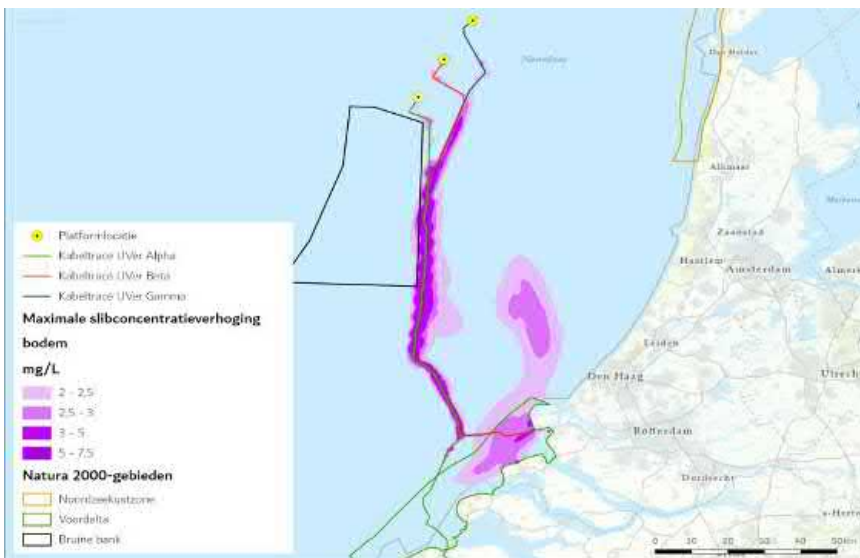
Figur 92 Cumulatie van de maximale omvang baggerpluimen van Net op zee IJmuiden Ver Alpha, Beta en Gamma gedurende de gehele simulatieperiode voor wateroppervlak (boven), dieptegemiddeld (midden) en bodem (onder). Betreffende worst-case combinatie van maximale vertroebeling. De concentratieverhogingen door de werkzaamheden zijn, aan de hand van een kleurschaal, weergegeven als daggemiddelde (mg/L).
