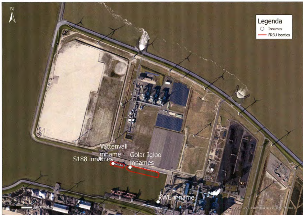
Figuur 3-4: Waterinnames in de Eemshaven
