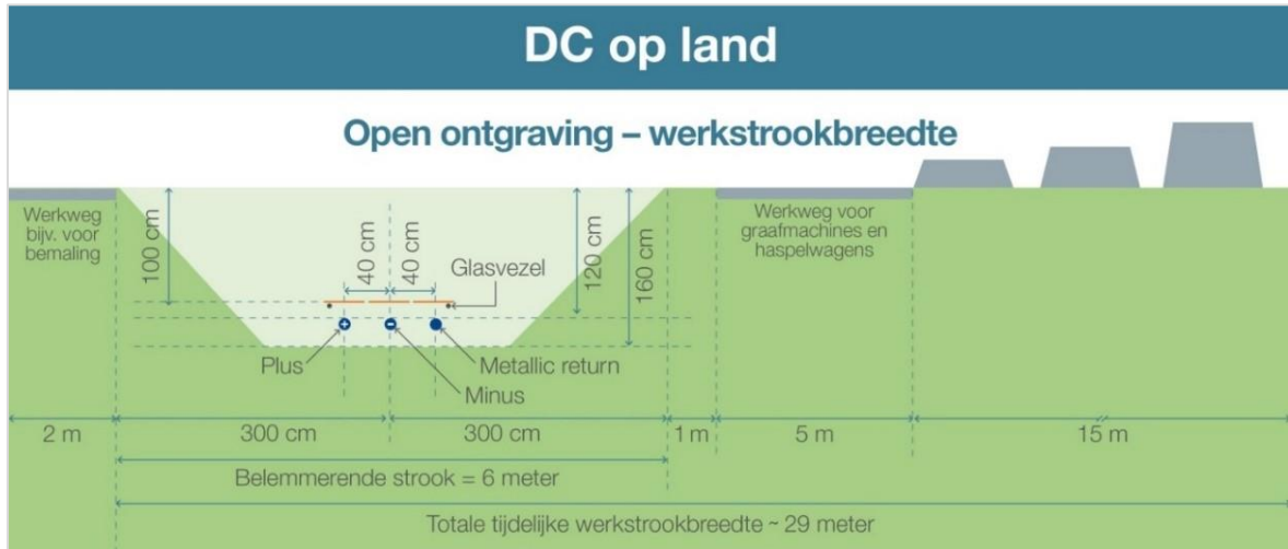
Figuur 2.9 De kabelconfiguratie en werkstrookbreedte bij open ontgraving van Net op zee IJmuiden Ver Gamma.
