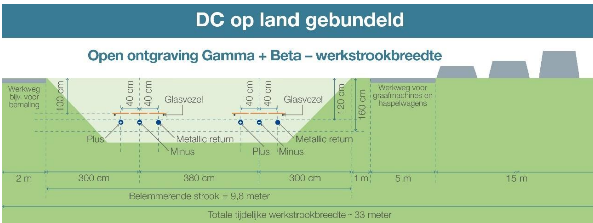
Figuur 2.10 De kabelconfiguratie en werkstrookbreedte bij open ontgraving van Net op zee IJmuiden Ver Beta en Gamma
