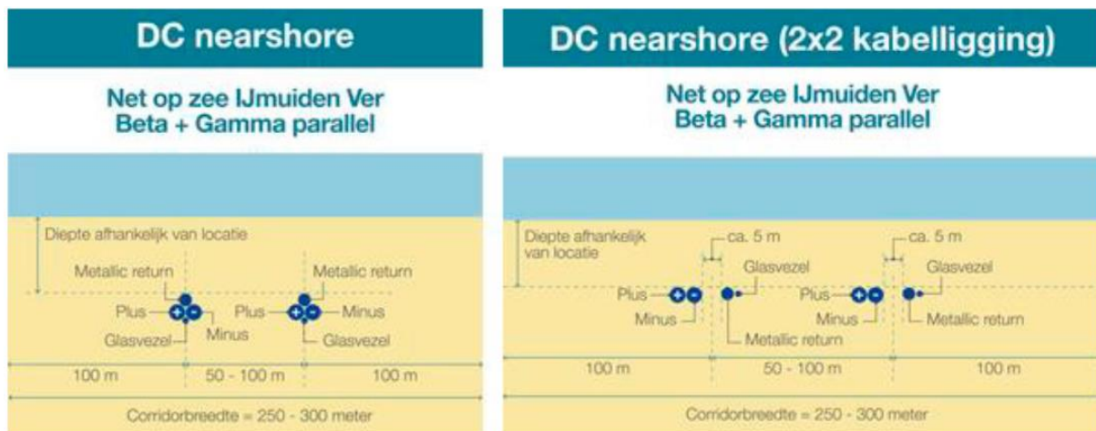
Afbeelding 5. Corridorbreedte nearshore bij parallelligging van Net op zee IJmuiden Ver Gamma en Net op zee IJmuiden Ver Beta (bron: TenneT).
