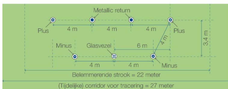
Figuur 2.10 Vergunningszone HDD-boringen Beta en Gamma
