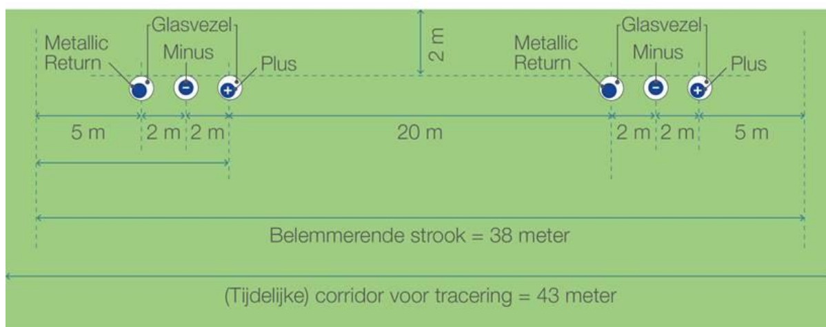
Figuur 2-2 Configuratie kabelsysteem persingen DC-verbinding
