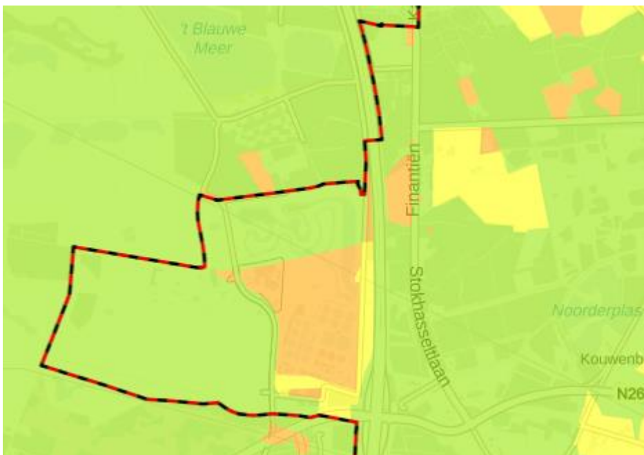
Figuur 4: gevoeligheidsfactor voor berekening watercompensatie, groen=1, geel=1/2, oranje=1/4 (bron: Kaart Algemene regel afvoer regenwater door verhard oppervlak)
