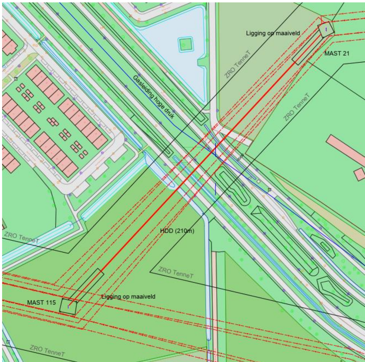
Figuur 1: overzicht tijdelijke 150kV kabelverbinding M115 – M21.
